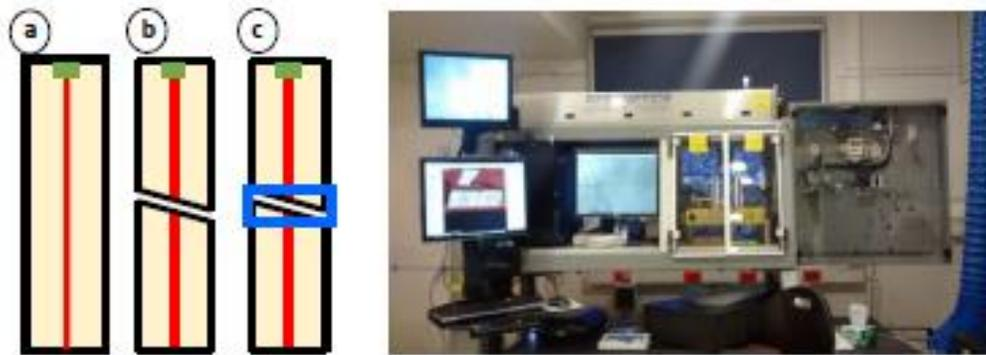
Figura 13 a, b y c muestra la estalagmita original en amarillo y en rojo el eje de crecimiento en secuencia al corte en diagonal al final del segmento. La imagen de la izquierda muestra el equipo LA-ICP-MS (imagen de Corona Martínez, 2017).
