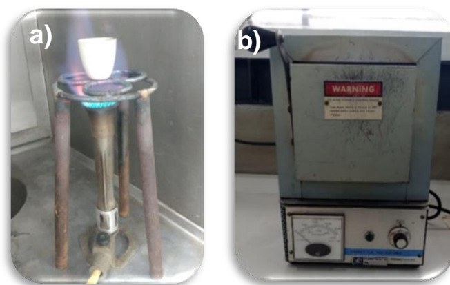
Figura 22. Incineración de muestra y Mufla Sybron.
