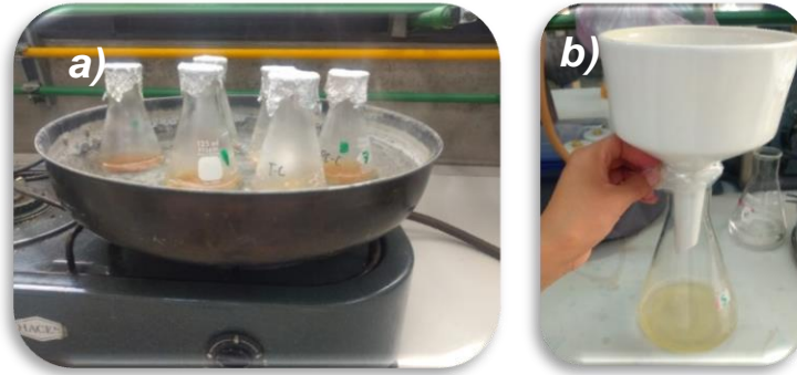
Figura 53. a) Matracas con muestra y en un baño a 60 °C, b) Filtración para determinación de fibra dietética
