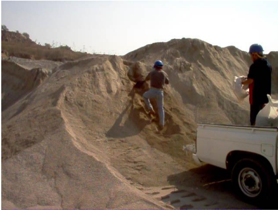
Muestreo de los agregados petreos en la planta para la elaboracion del concreto asfaltico.
