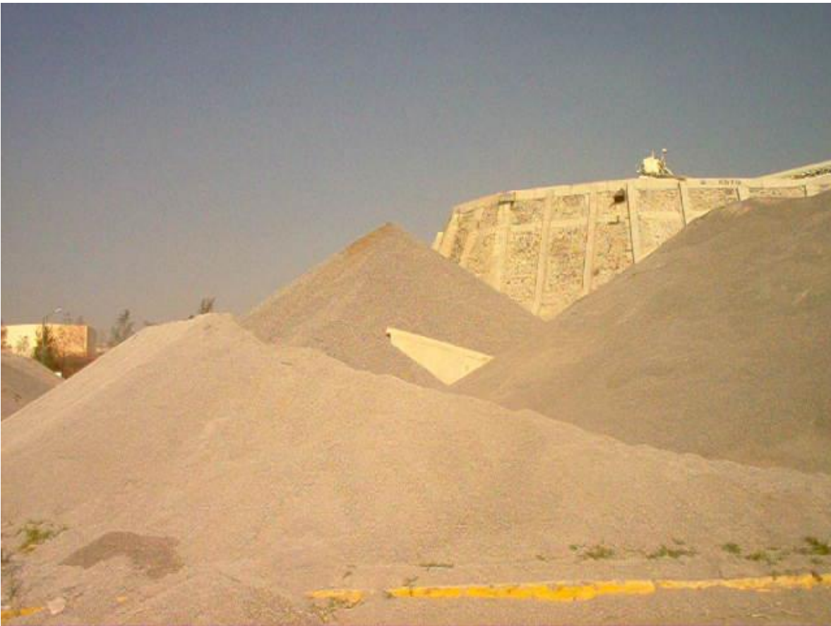
Banco de agregados pétreos para la carpeta asfáltico (diseño Marshall).
