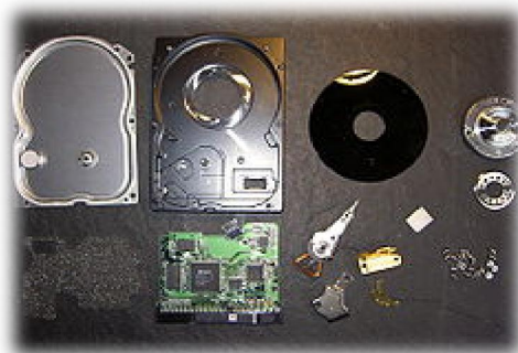
Imagen 1.3.1.1 Estructura física de un HDD. De izquierda a derecha, fila superior: tapa, carcasa, plato, eje; fila inferior: espuma aislante, circuito impreso de control, cabezal de lectura / escritura, actuador e imán, tornillos.
