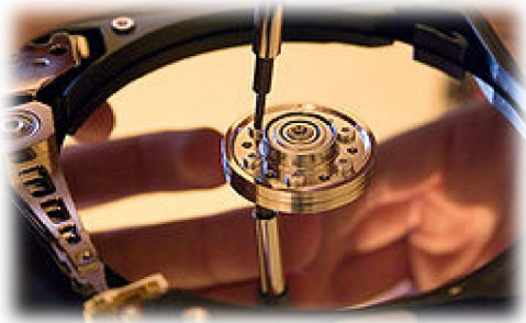
Imagen 1.3.1.2 Superficie de un plato y el cabezal de lectura/escritura.
