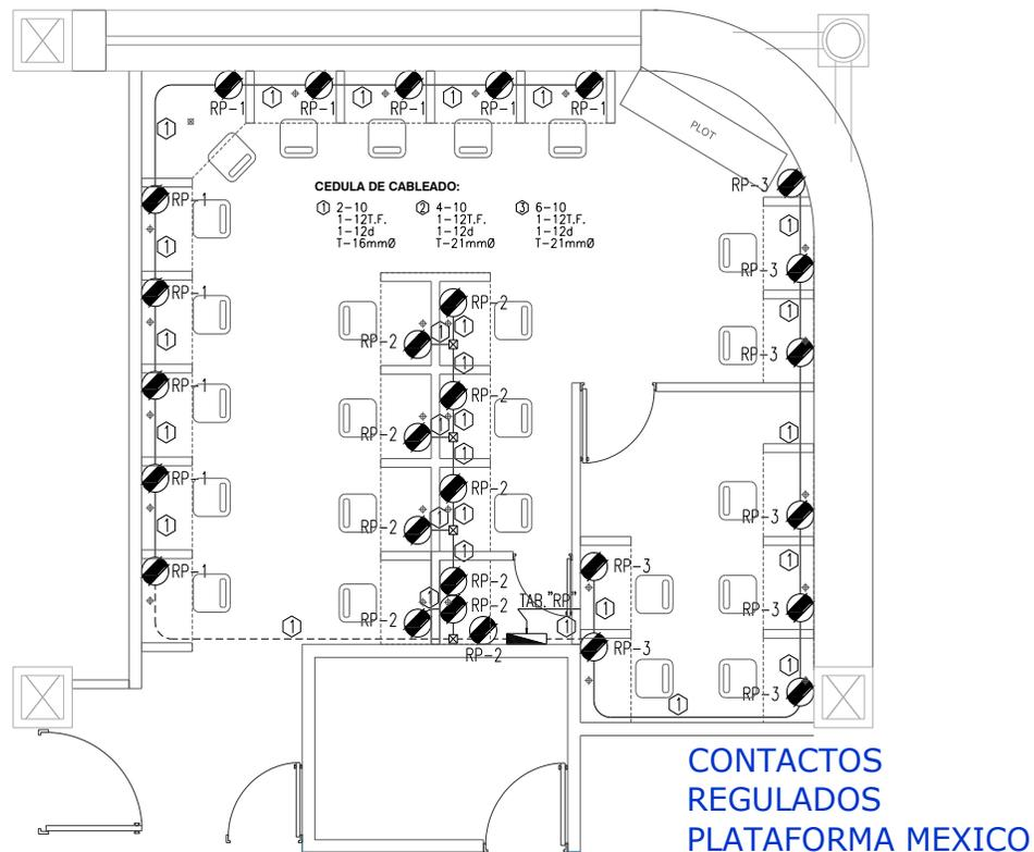
**Fig. 3.12 Distribución de circuitos derivados del sistema regulado.**
