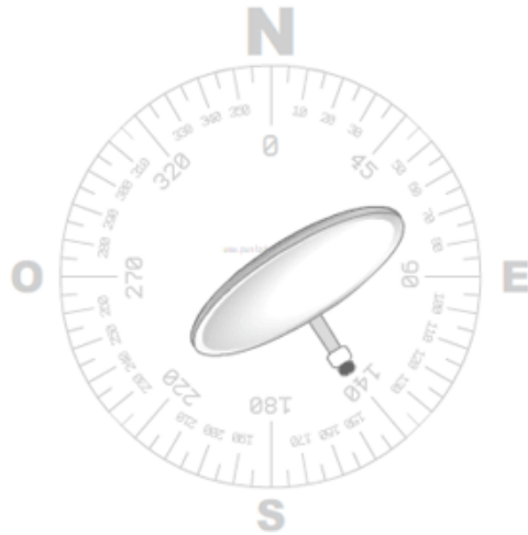
Figura 5.5. Movimiento del ángulo de azimut
