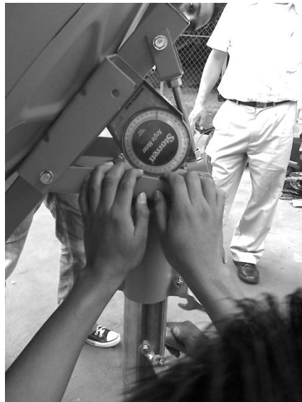
Figura 5.7. Utilización del inclinómetro para ajustar el ángulo de elevación
