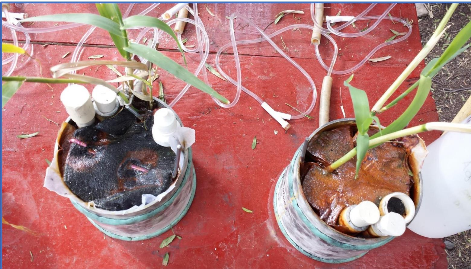
**Figura 40.** Corrosión presente en celdas de combustible microbianas vegetal de alambre
