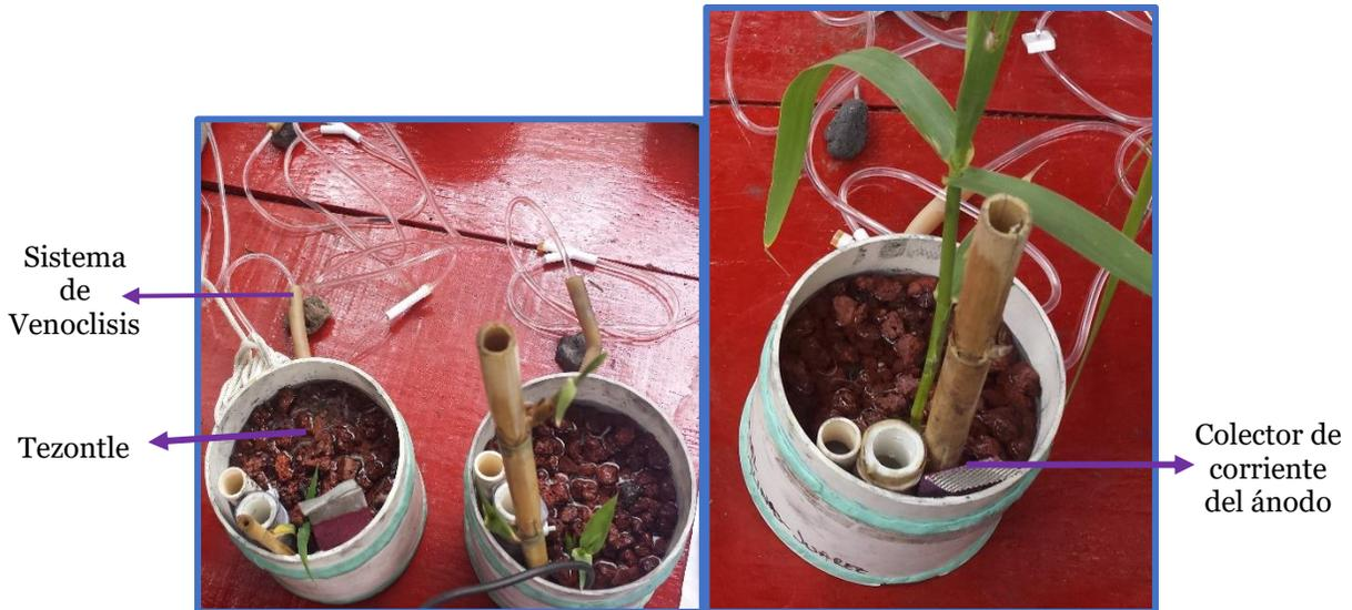
**Figura 21.** Celdas de combustible microbianas con sistema de venoclysis incorporado y tezontle con *Phragmites Australis*
