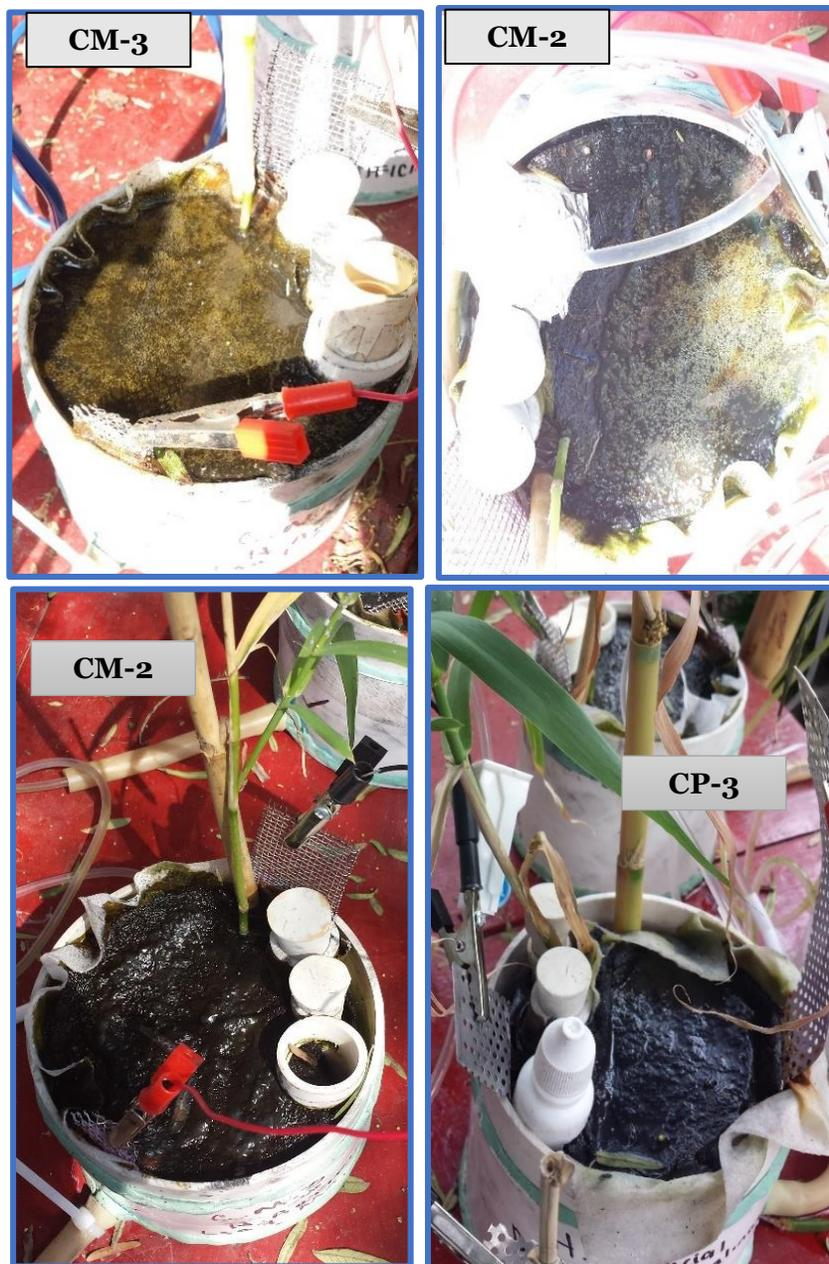
**Figura 35.** Crecimiento de microalgas en cátodos con malla de alambre (arriba). Colocación de grafito en polvo en cátodos con malla de alambre y placa (abajo).
