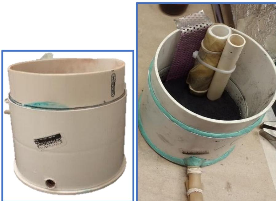
**Figura 19.** Vista lateral de material PVC con orificio inferior para celda de combustible microbiana (izquierda). Vista superior de colector anódico y tubos para muestreo (derecha).
