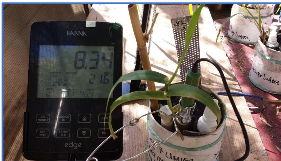
**Figura 28.** Uso de electrodo para pH de Multiparamétrico en zona anódica de celda de combustible microbiana vegetal (CM-2)
