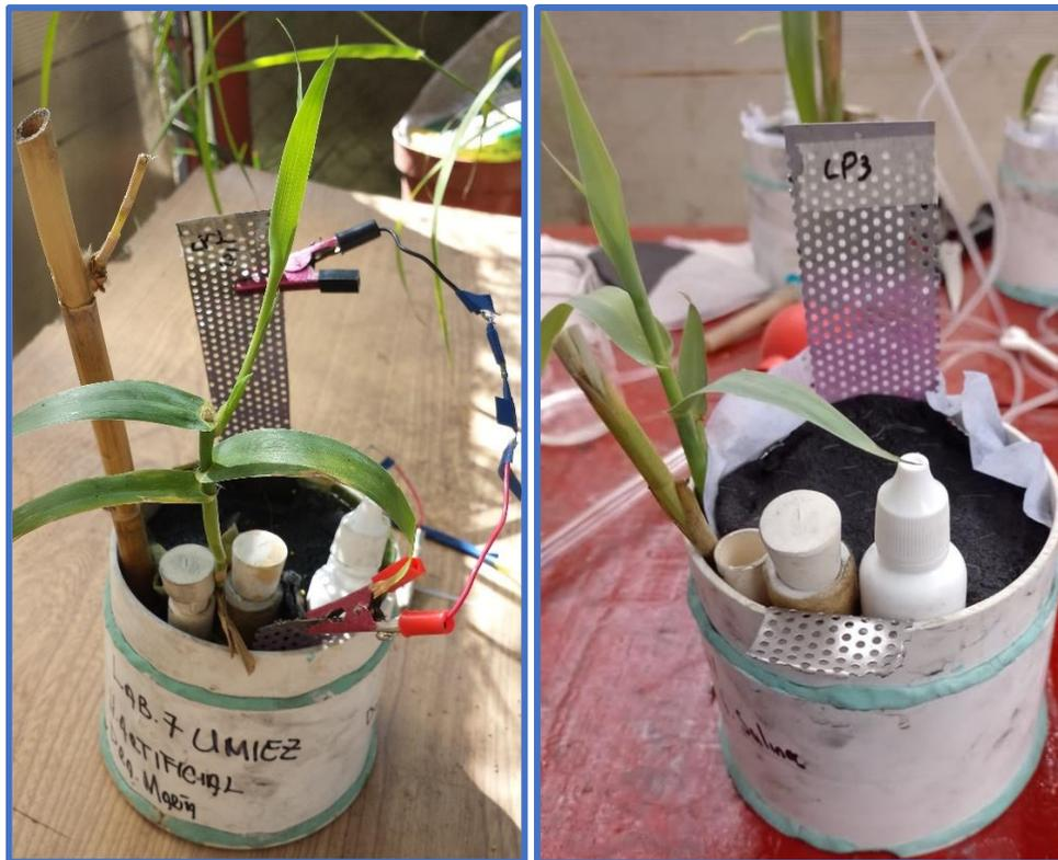
**Figura 22.** Celda de combustible microbiana vegetal con resistencia  $11.3\text{ K}\Omega$  (izquierda). Celda de combustible microbiana vegetal en circuito abierto con tela pellón en cátodo (derecha)
