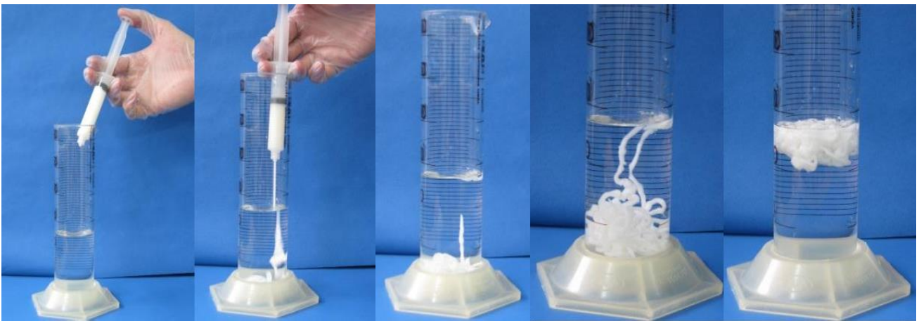
Imagen 8. Secuencia de formación de la balsa. (Laboratorio de tecnología farmacéutica, 2023)
