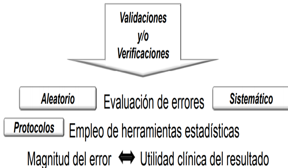
Figura 16. Esquema que define el objetivo de la evaluación de un método de medida (Westgard, 2013). En el laboratorio clínico diariamente se realizan mediciones las cuales conllevan algún tipo de error (aleatorio/sistemático), evaluar un procedimiento de medida implica conocer el error, empleando herramientas estadísticas (protocolos) para cuantificar los errores. La magnitud obtenida se compara con las especificaciones de desempeño declaradas por los fabricantes o se compara la magnitud de los diferentes tipos de errores con un requisito de calidad establecido (validación del procedimiento de medición) (Westgard, 2013).
