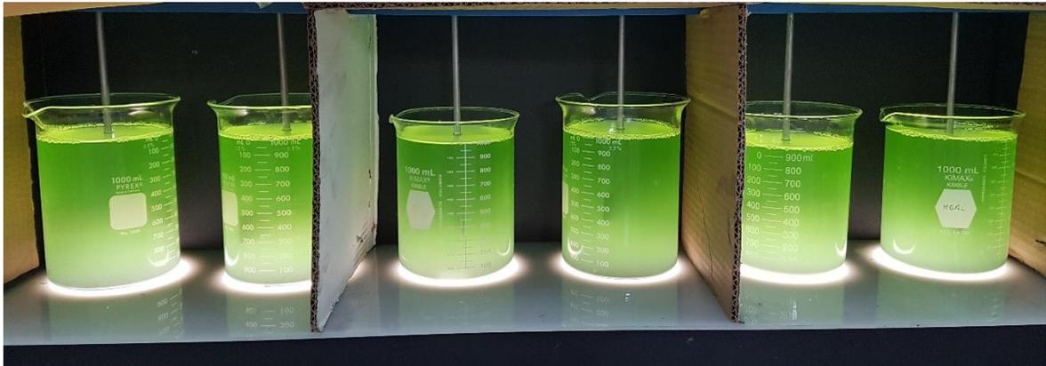
*Ilustración 13. Inicio de prueba de jarras con solo 20 mg/L de SST*
