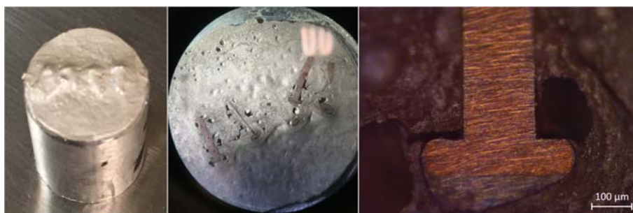
Fig. 16. Fotografías del proceso de preparación de muestra, de izquierda a derecha: muestra soportada y cubierta con tintura de plata en el portamuestra; imagen obtenida con un microscopio después de iniciar el devastado; y muestra observada por microscopio al finalizar la preparación de la muestra.
