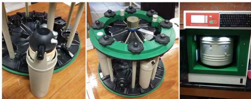
Fig. 18. De izquierda a derecha: tubo de reacción con chaqueta de presión, carrusel y reactor de microondas.
