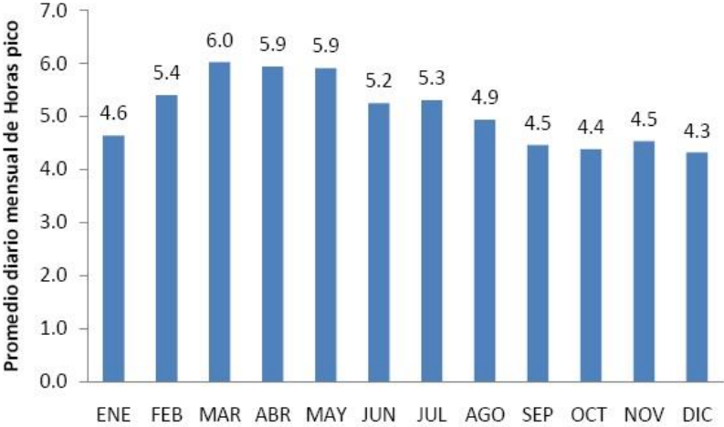
Figura 2-24. Promedio diario mensual de horas pico de radiación solar en la Ciudad de México.
