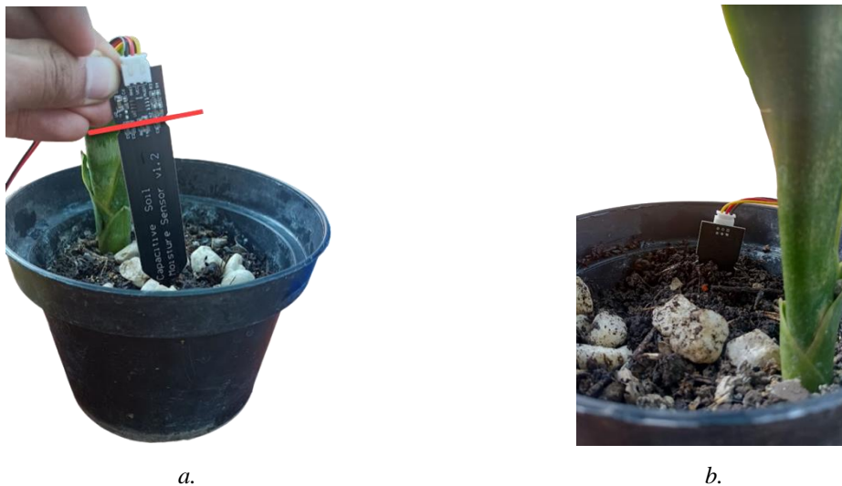
Figura 4.1 Manera de colocar el higrómetro capacitivo dentro del sustrato.
