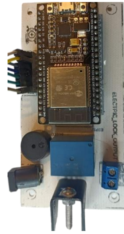
c. PCB apertura de puerta mediante RFID.
