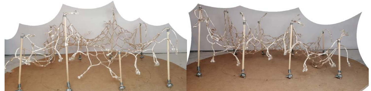
Vista lateral de la malla colgando. En la izquierda se ocuparon los postes intercalando su tamaño, en la derecha se colocan de mayor a menor.
