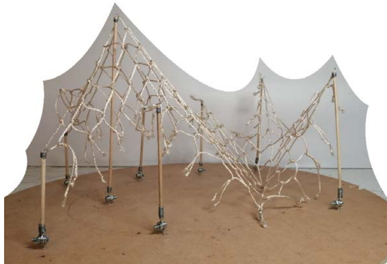
Vista lateral opuesta. La corta dimensión de la malla sugirió eliminar un poste cercano al punto bajo, rompiendo la simetría y dando otro diseño.
