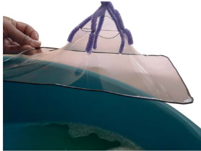
Conoide que puede ejemplificar un borde libre, al estar delimitado por un hilo colgando y no un alambre rígido.
