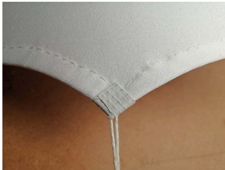
Detalle de accesorio de unión y refuerzo con lona
