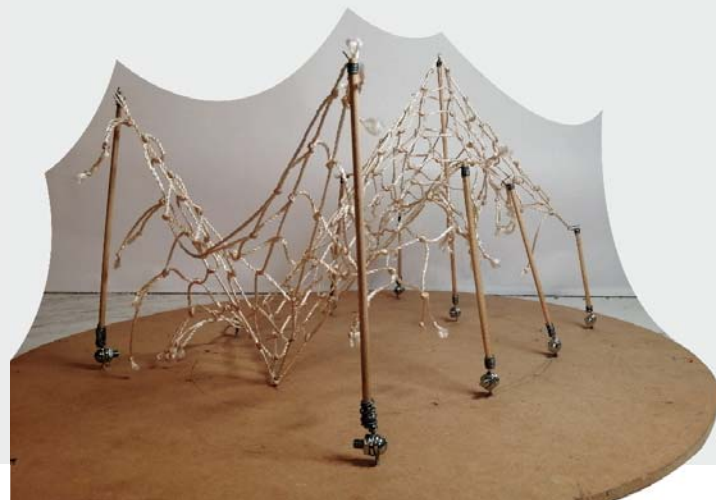
Perspectiva. La tensión en la malla provoca una inclinación opuesta a la deseada en algunos postes.
