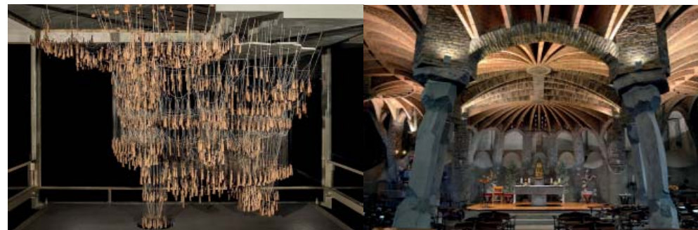
18 Modelo reproducción de la Iglesia de la colonia Güell elaborado por estudiantes de la Universidad de Stuttgart y el prof. Frei Otto. 19 Iglesia de la Colonia Güell
