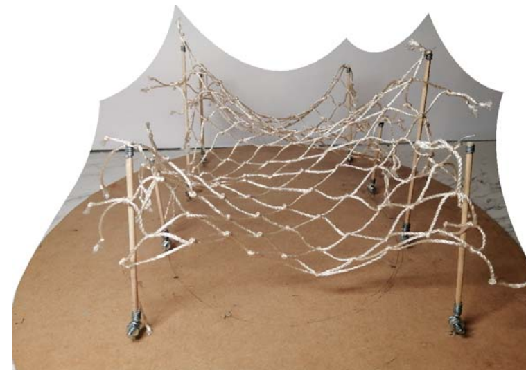
Malla suspendida intercalando el tamaño de postes entre elevados y otros de menor altura.
