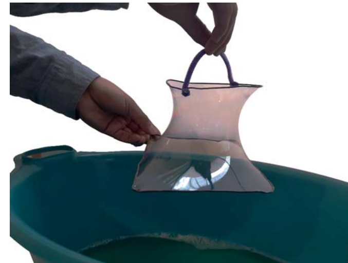
Aumentando pocos milímetros la altura, la superficie (curvatura) se transforma radicalmente.
