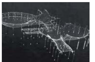
34 Centro Multifuncional de Mannheim. Maqueta colgante escala 1:100 con pesos para la obtención de la forma.
