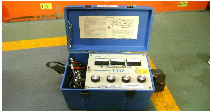
*Figura 1.6 Medidor de relación de transformación trifásico.*
