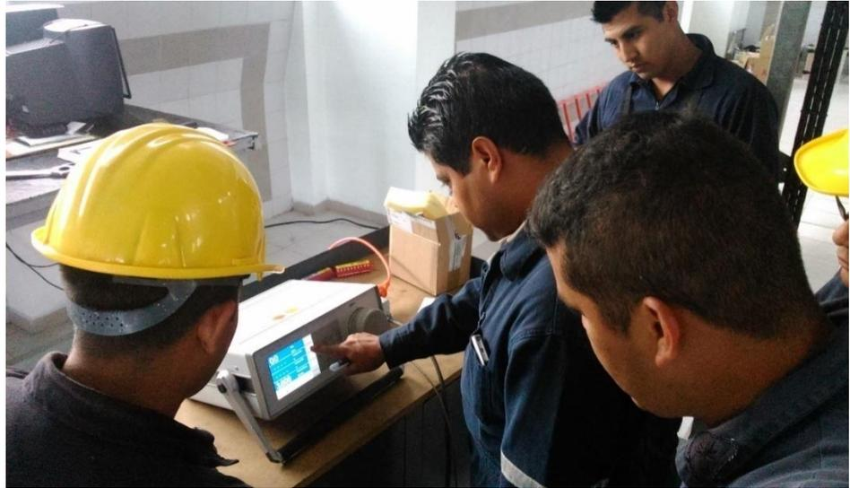
*Figura 3.5 Equipo con el que se analizó el gas SF6 contenido en las bahías*
