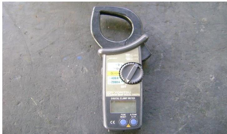
*Figura 1.7 Amperímetro marca Kyoritsu.*
