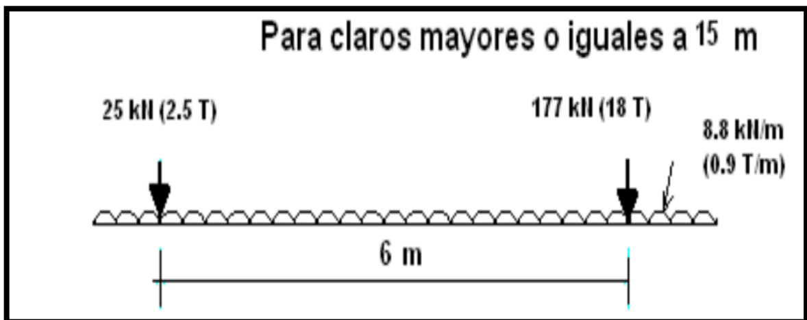
Fig. Modelo de cargas vivas vehiculares IMT 20.5, para el análisis longitudinal de puentes y estructuras similares, con claros iguales o mayores de 15m.
