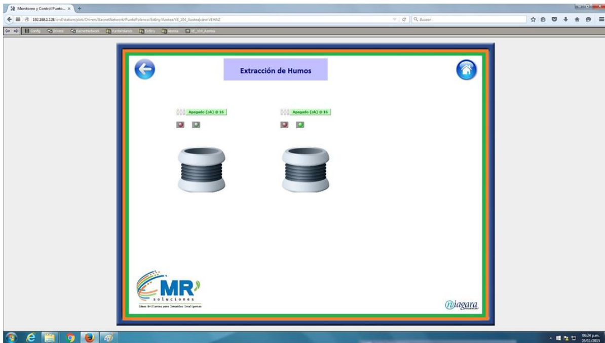
FOTO 76. PANTALLA DEL SISTEMA BMS PARA MONITOREO DEL SISTEMA DE EXTRACCIÓN DE HUMO
