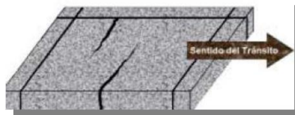
a) Esquema de Fisura transversal o diagonal
