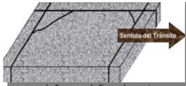
c) Esquema de Fisura de esquina
