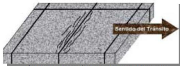
c) Fisura por mal mantenimiento de juntas.
