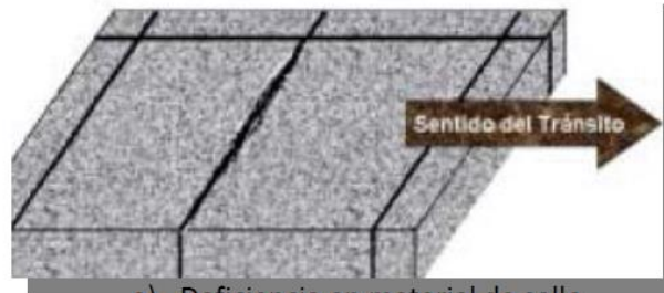
a) Deficiencia en material de sello.
