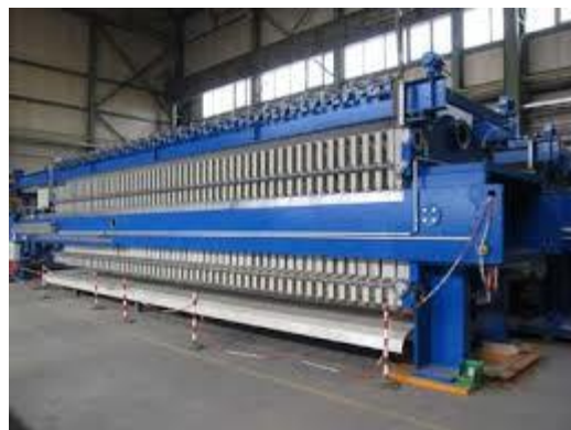
Fig. 2.11. Filtro horizontal (archivo personal de GMSI)
