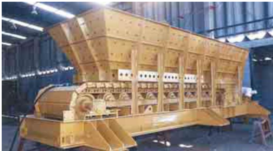
Fig. 2.17. Alimentador de placas con su chute de descarga que se conecta a la boca de descarga de la pila (Crushing and Screening Handbook de METSO)
