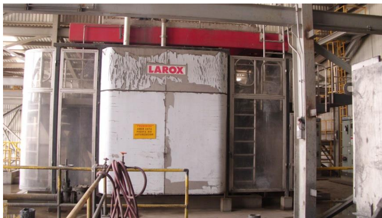
Fig. 2.10. Filtro vertical marca larox (archivo personal de GMSI)
