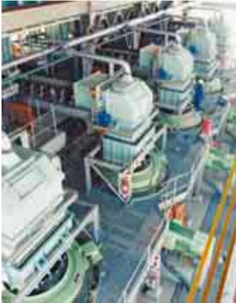
Fig. 2.18. Vista de edificio de trituración secundaria, se muestra la descarga del transportador a un chute y esta descarga a la trituradora secundaria de cono (Crushing and Screening Handbook de METSO)
