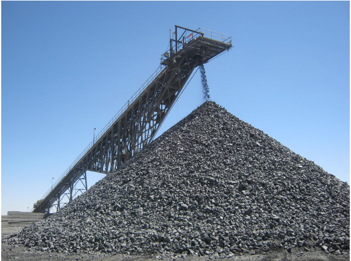
Fig. 2.16. Pila de almacenamiento de mineral, debajo de esta se encuentran los alimentadores de banda o placa que reclaman el material (archivo personal de GMSI)
