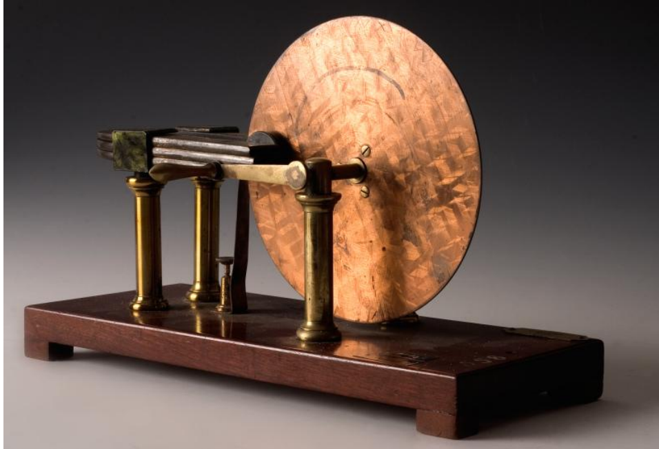
Figura 7. Primer generador electromecánico de Faraday (1831). Faraday 's Disc demonstration model, Physics Collection, University of Dundee Museum Services. Fotografía de Noel Shelley.
