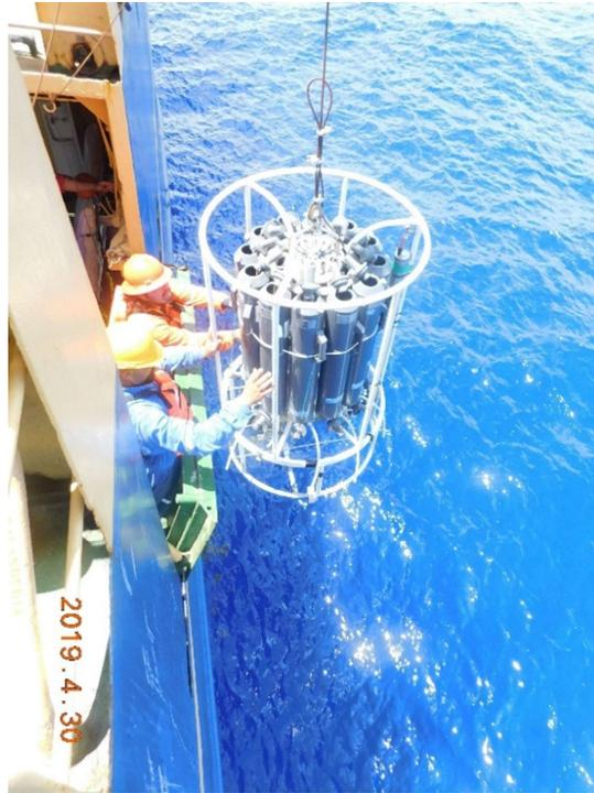
**Figura iii. Mediciones de CTD y maniobra de cubierta para realizar las hidrocalas a diferentes profundidades.**
