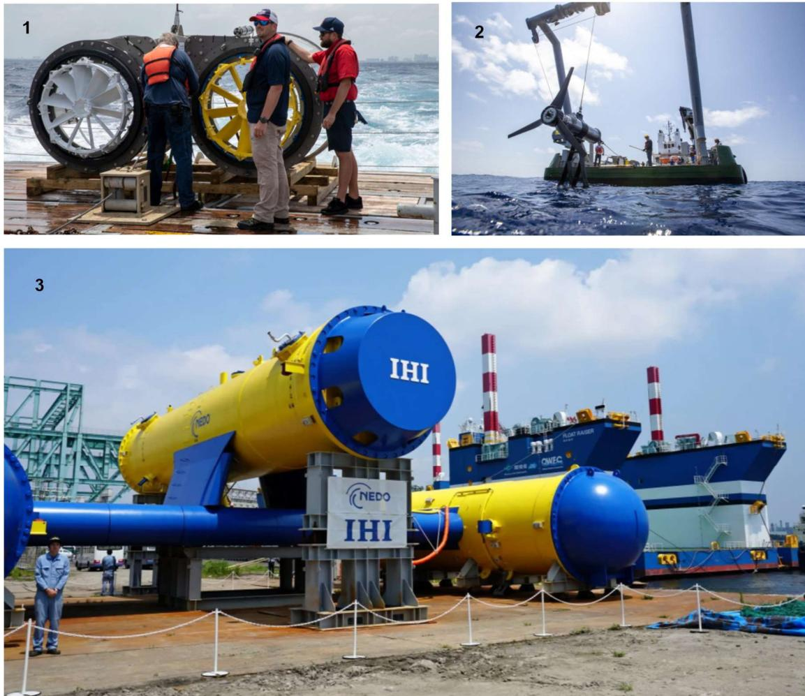
**Figura 6. Tecnología para corrientes oceánicas. Dos prototipos instalados en la corriente de Florida y para la corriente de Kuroshio Japón, (Ferrara, 2022), (Ocean Based, 2017), (IHI Corporation, 2014).**
