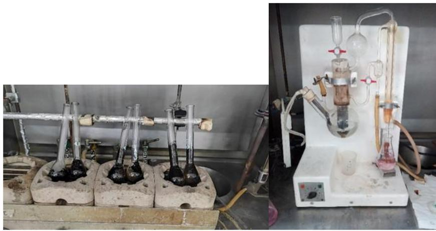
**Figura 28.** a) Etapa de digestión, b) destilador micro Kjeldahl.
