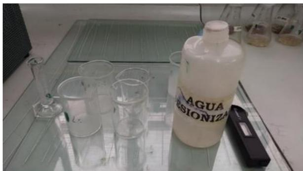
**Figura 25.** Material utilizado para determinar la conductividad eléctrica en linaza.
