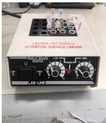
**Figura 35.** Evaporación en plancha de calentamiento.
