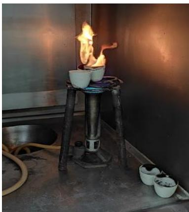
**Figura 27.** Incineración de las muestras.
