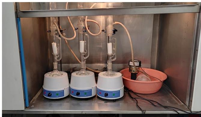
**Figura 29.** Extracción de grasa por método Soxhlet.
