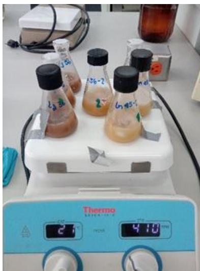
**Figura 32.** Hidrolisis enzimática para la obtención de almidón total.
