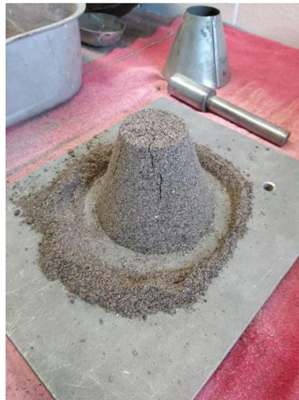
**Imagen 7- Agregado fino después de retirar el molde para determinar el estado SSS (fuente propia).**
