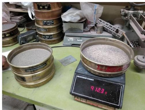
***Imagen 3 y 4- Proceso de tamizado y pesaje de cada material que pasa por las cribas (fuente propia).***
