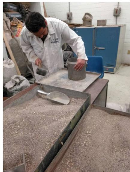
*Imagen 5 y 6- Masa volumétrica seca suela y compactada de agregado grueso y fino (fuente propia).*
