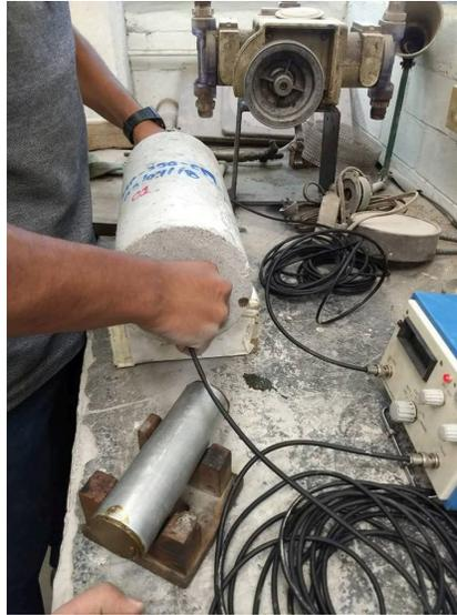
*Imagen 12- Transmisión directa de un espécimen de concreto para determinar la velocidad de pulso (fuente propia).*
