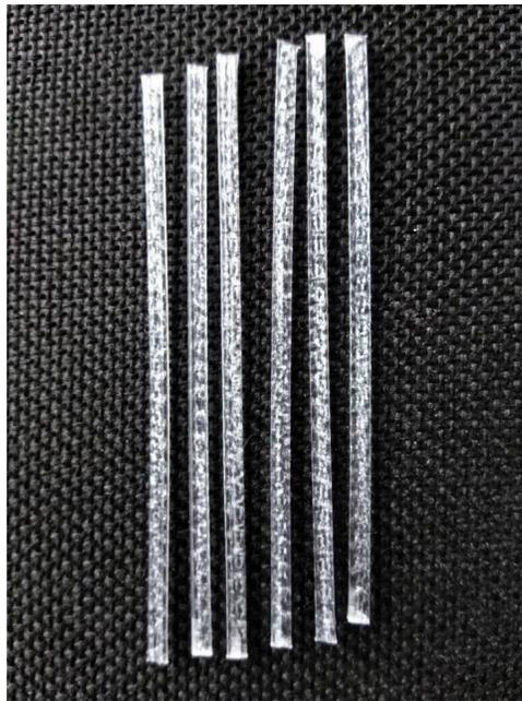
*Imagen 15- Fibras de polipropileno usadas en las mezclas (fuente propia).*
