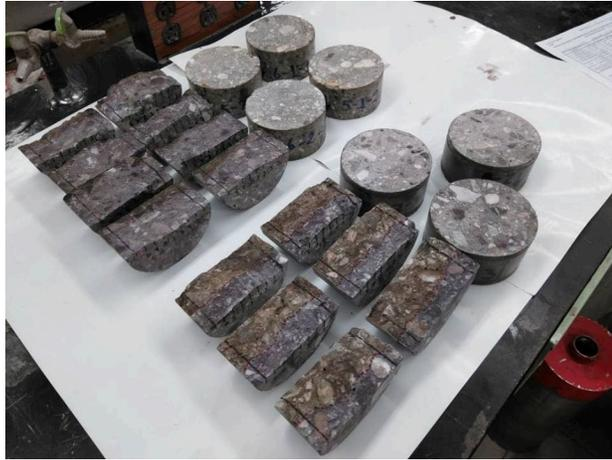
*Imagen 13 y 14- Penetración de ion cloruro de muestras sometidas a la prueba para determinación del coeficiente de migración (fuente propia).*
