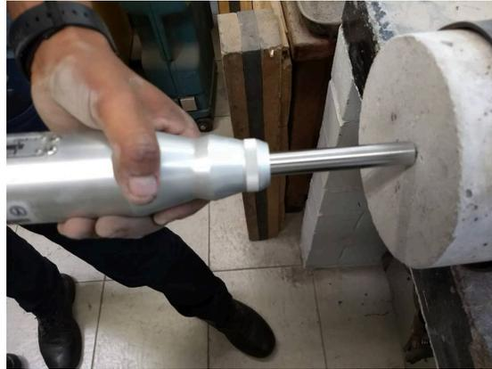
*Imagen 9 y 10- preparación de la superficie y aplicación del esclerómetro (fuente propia).*
