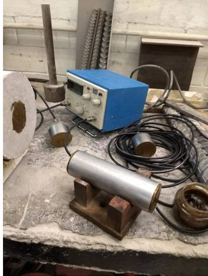
**Imagen 11- Aparato generador de pulso ultrasónico (fuente propia).**
