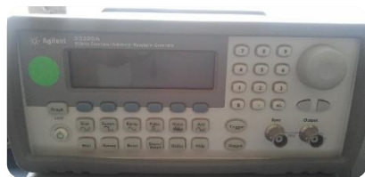
Generador de Funciones.
