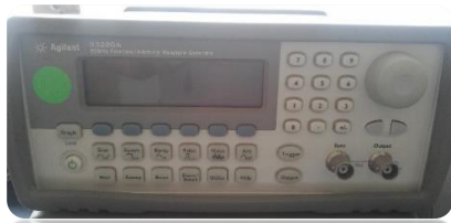
Generador de Funciones.
