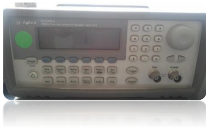
Generador de Funciones.
