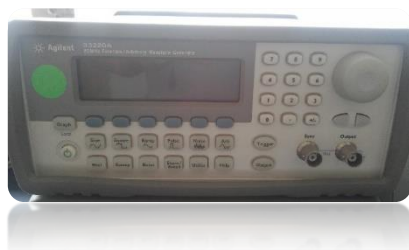
Generador de Funciones.
