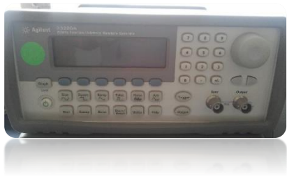
Generador de Funciones.
