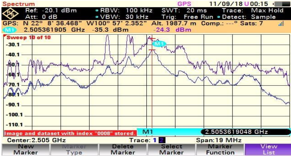
Ilustración 4.17: Se observa una emisión radioeléctrica con un ancho de banda de 20 MHz. en el segmento de 2500-2530 MHz. la emisión inicia en la frecuencia 2.495 GHz. y termina en la frecuencia 2.515 GHz, a un metro de distancia de la antena transmisora, pertenece a una cámara de video vigilancia inalámbrica.
