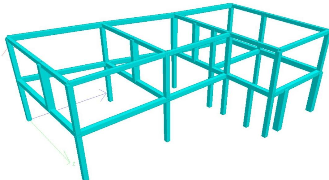
*Imagen 2.6 e) Imagen 3D del Modelo estructural de dalas y castillos.*
