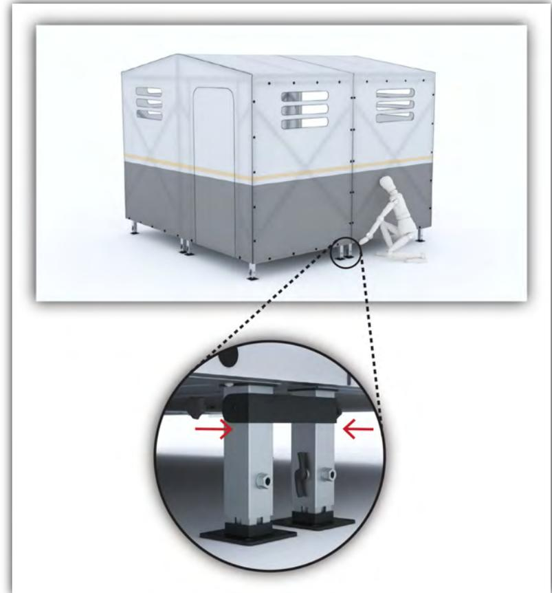
Figura 109. Colocación de abrazadera en patas niveladoras situadas en la parte inferior del habitáculo.
