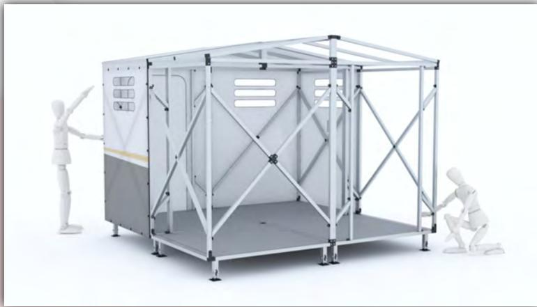
Figura 107. Armado y posicionamiento de estructura correspondiente a otra unidad del habitáculo.
