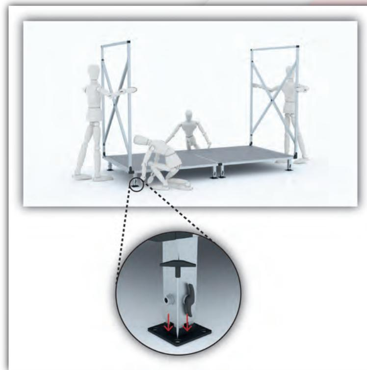
Figura 96. Colocación opcional de estacas de metal en los orificios de los tapones inferiores de las patas niveladoras.
