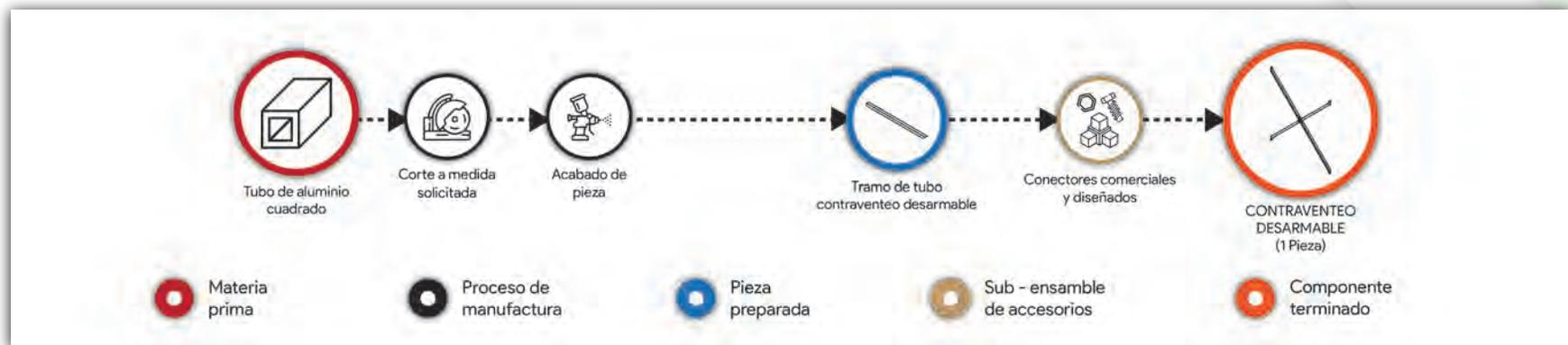
Figura 134. Transformación de materiales y manufactura de piezas que comprenden el conjunto contraventeo desarmable del habitáculo.
