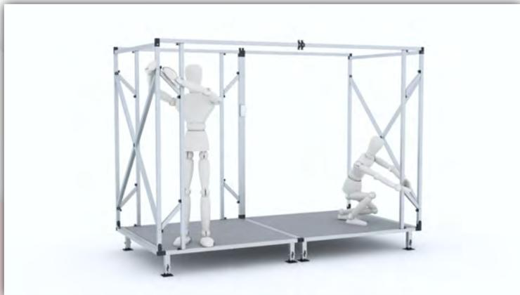
Figura 101. Ensamble de soportes de puerta que servirán como columnas medias en los otros extremos de los muros.
