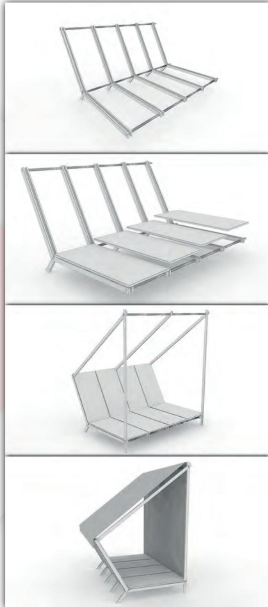
Figura 49. Secuencia de armado de primera propuesta. De arriba a abajo: Apertura de estructura, colocación de paneles de piso, ensamble de techo y colocación de lona.
