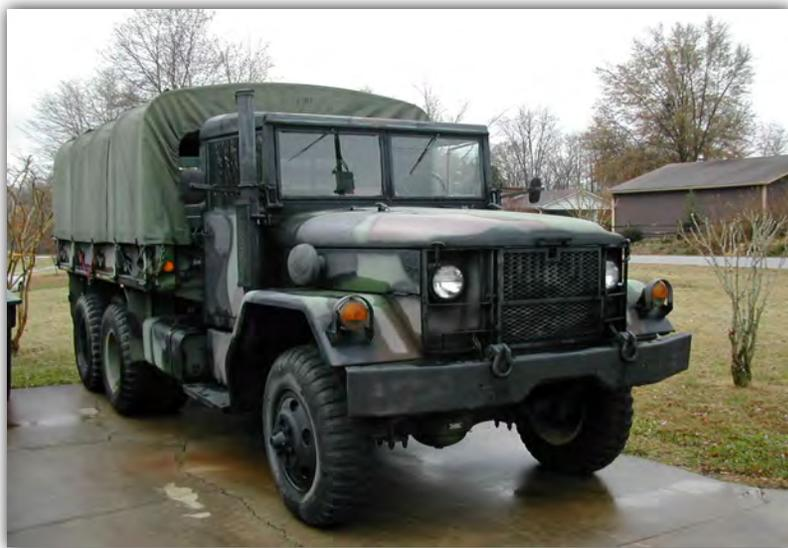
Figura 19. Camión de transporte de carga y de tropas mod. M35 2-1/2 ton. cargo truck.
