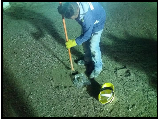
Ilustración 62. Pruebas de compactación.
