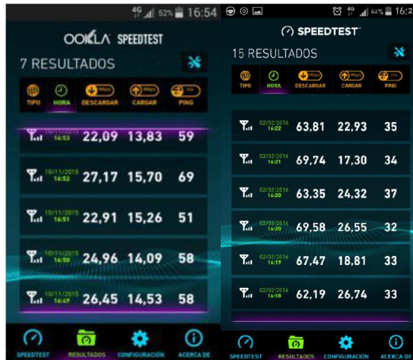
Figura 4.45: Prueba de velocidad realizada a una celda LTE
