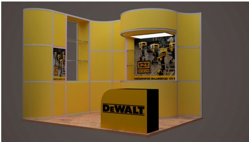
Ilustración 4. Render de un stand en sistema modular proyectado para realizarse con perfiles extruidos de aluminio. Imagen propia.
