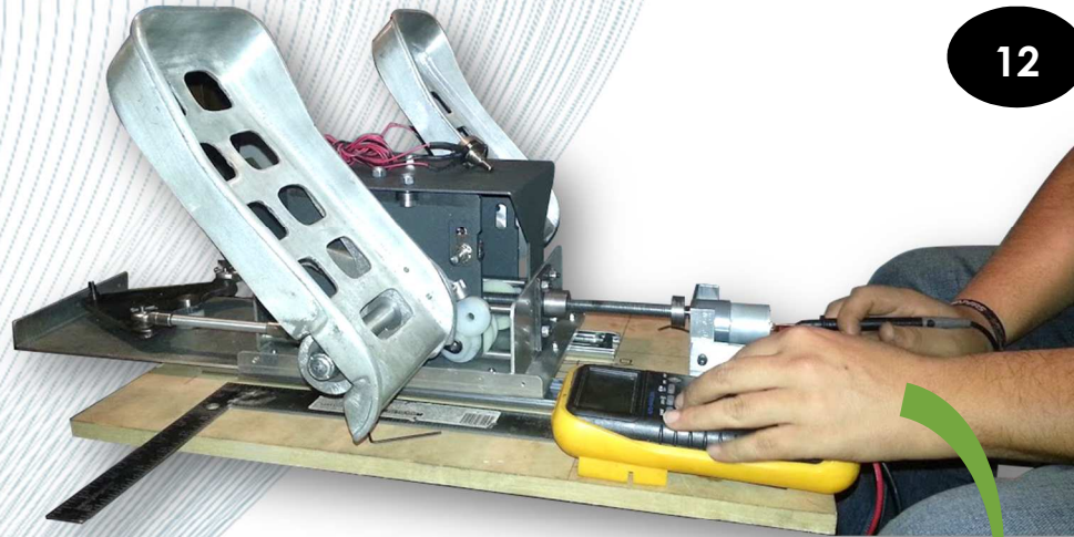
Figura 12 Primer modelo y pruebas del sistema de arrastre a partir de tornillo sí fin tipo ACME por medio de un Moto reductor de metal 37Dx57L mm, 12 V: 100 RPM y 300 mA libre, 220 kg de espacio (16 kg-cm) y 5 A de parada.
