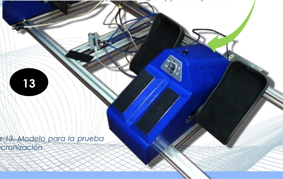
Figura 12 Primer modelo y pruebas del sistema de arrastre a partir de tornillo sí fin tipo ACME por medio de un Moto reductor de metal 37Dx57L mm, 12 V: 100 RPM y 300 mA libre, 220 kg de espacio (16 kg-cm) y 5 A de parada.
