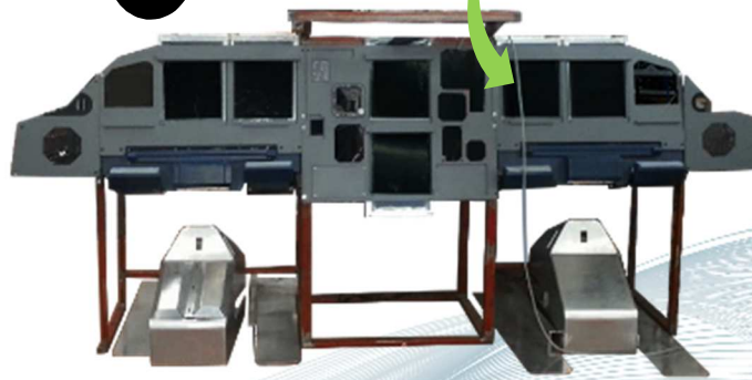
Figura 3. Se corteja el volumen con respecto a la estructura de MIP; componentes que pudiera intervenir en el correcto control y funcionamiento de los pedales (como la mesa plegable y reposapiés o la misma estructura
