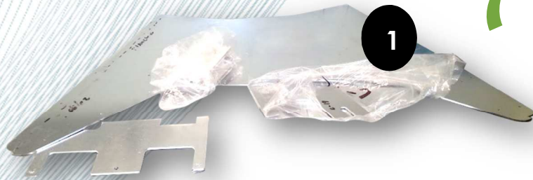
Figura 1. Corte laser de aluminio realizado para el primer prototipo
