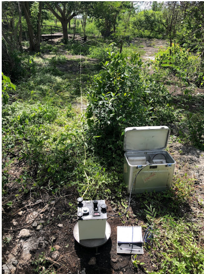
FIGURA B.1: Componentes adicionales que son indispensables para realizar la lectura utilizando el gravímetro LaCoste & Romberg modelo G-1117 .
