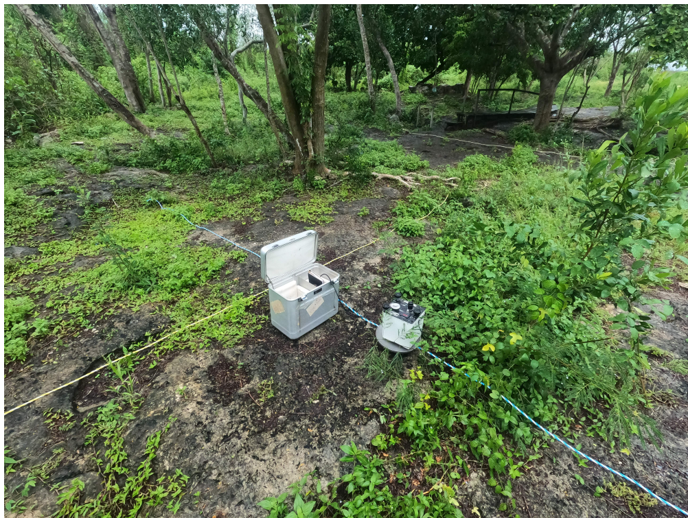
FIGURA 4.8: Fotografía del gravímetro LaCoste & Romberg modelo G-1117 utilizado en el levantamiento.
