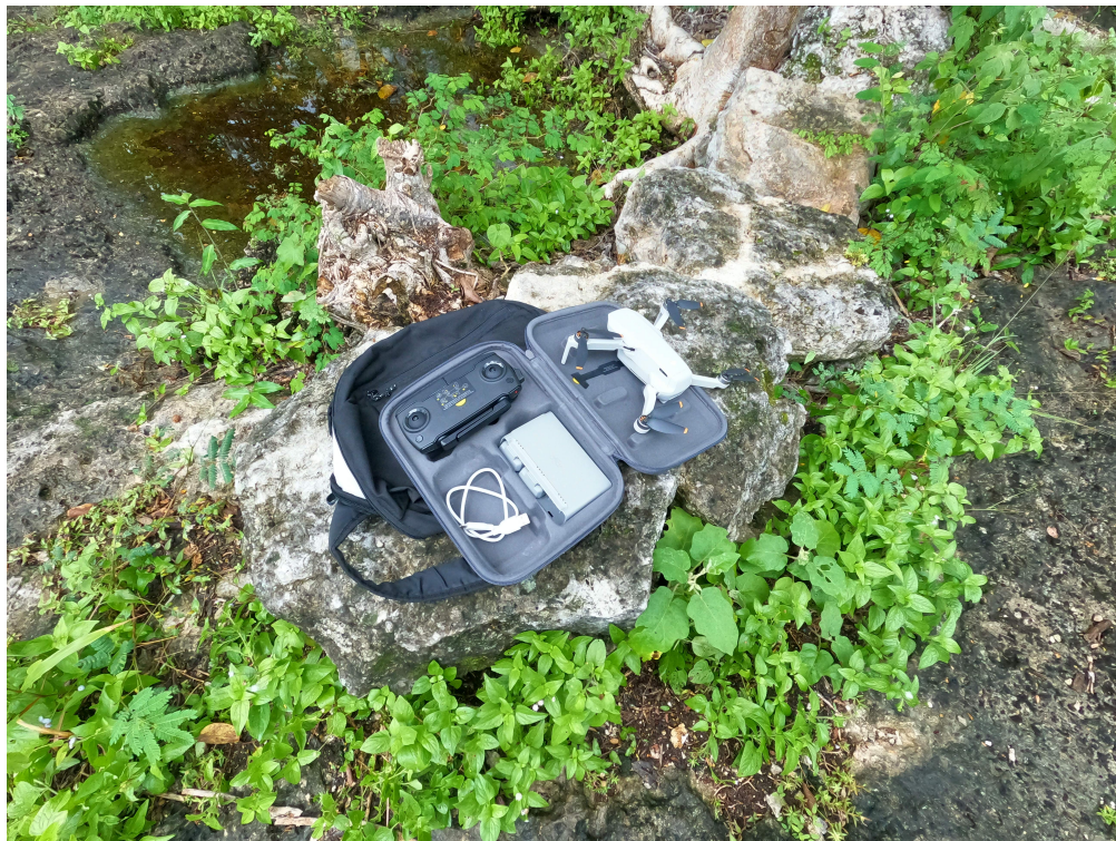
FIGURA 4.9: Fotografía del dron utilizado para la fotogrametría de la zona de estudio. El dron es un mini SE de la marca DJI, con un peso ( p < 249[g] ).
