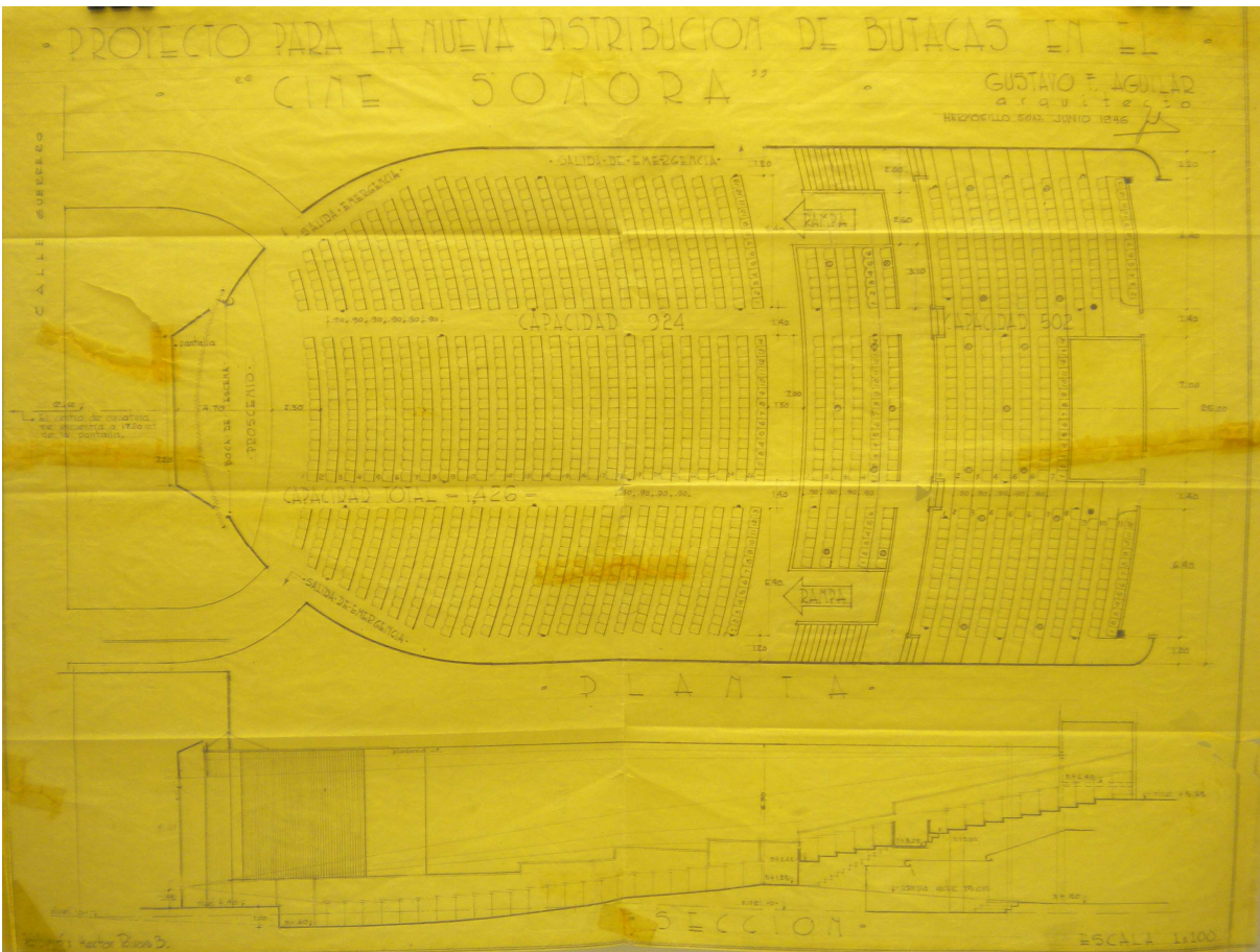
Imagen 63: Distribución de butacas en planta y corte del Cine Sonora.
