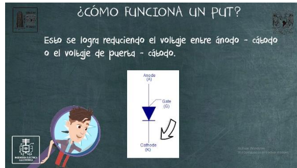
Ilustración 8.8-b Flujo de electrones a través del PUT.
