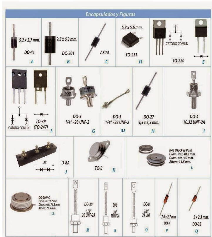
Ilustración 2.5 Diferentes tipos de encapsulados en los diodos.
