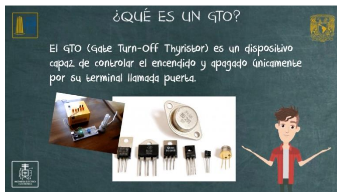
Ilustración 6.6 Descripción del GTO y el uso que emplea.
