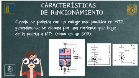
Ilustración 5.20-a Explicación de las distintas formas de polarización del TRIAC.
