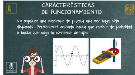
Ilustración 5.20-b Descripción de las características más comunes que se presentan en los TRIAC
