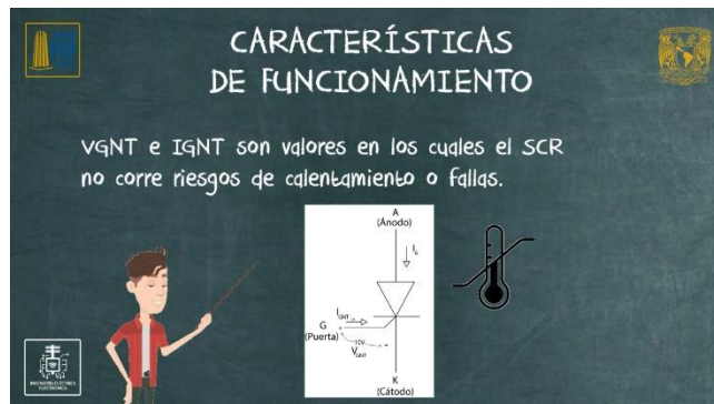
Ilustración 4.21 Explicación de los valores y datos a considerar para el funcionamiento en los SCR.
