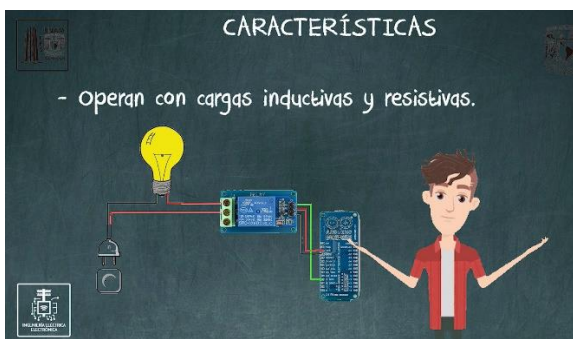
Ilustración 1.15-a Diagrama de conexión de un módulo de relevador a un Arduino.
