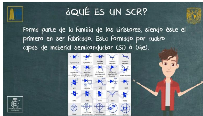
Ilustración 4.14 Explicación del SCR y la simbología de los diferentes tiristores.
