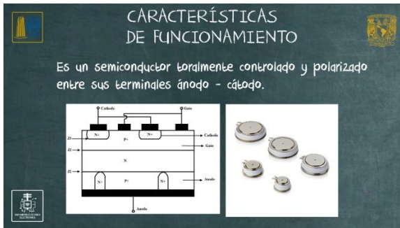
Ilustración 6.10-a Análisis de las diferentes capas con las que se compone un GTO.
