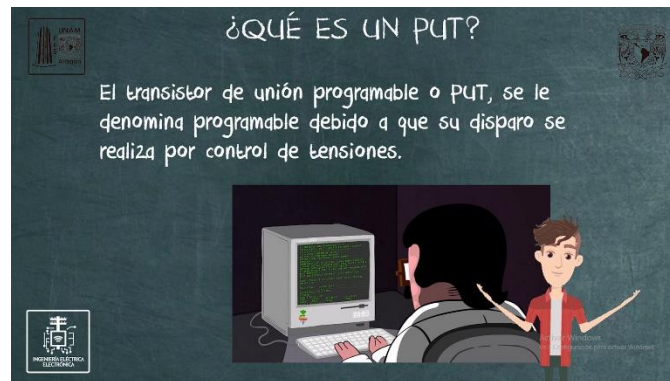
Ilustración 8.6 Funcionamiento del PUT como control dentro de los dispositivos de potencia.
