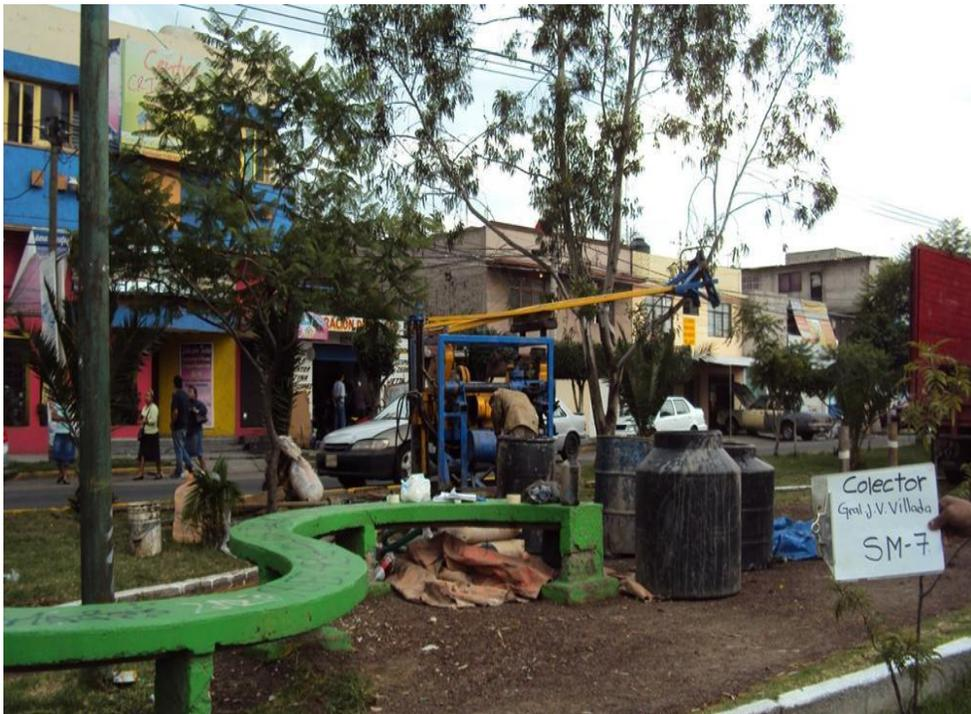
*Fotografía A.12 Imagen del sondeo mixto (SM-7) realizado, se aprecian las maniobras para la ejecución del sondeo.*
