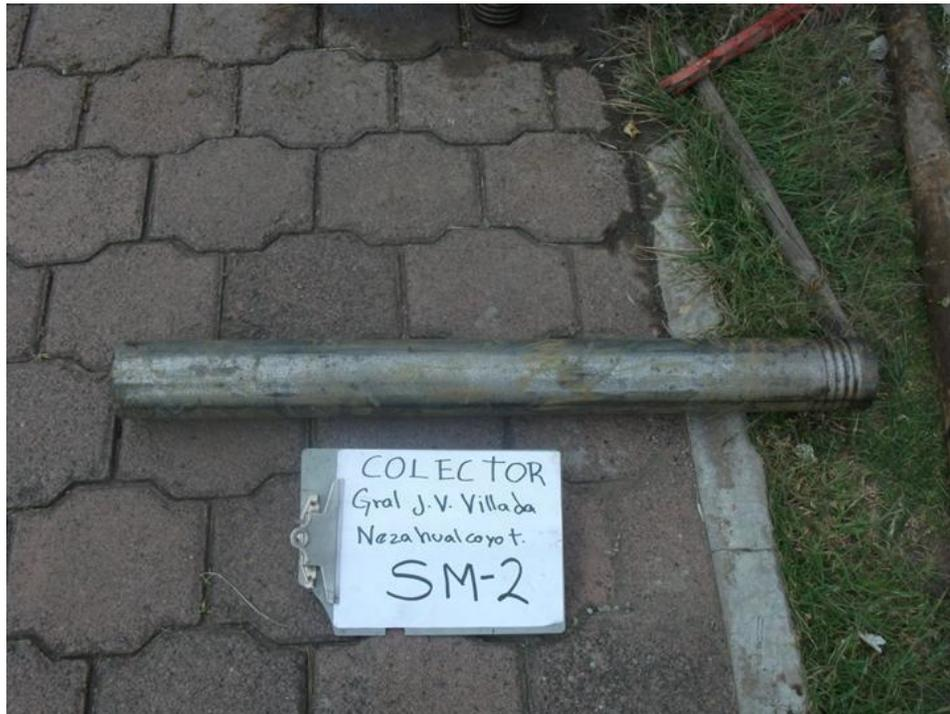
*Fotografía A.4 Se observa una muestra inalterada (tubo Shelby).*
