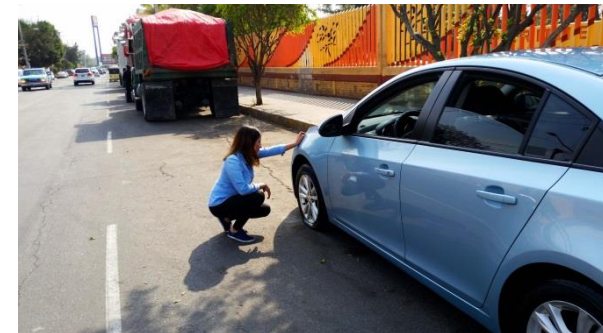
Fig. 12 Es preferible hacer el cambio de llanta de lado de la banqueta, es menos riesgoso.
