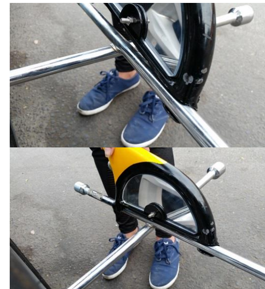
Fig. 50 La simetría de PALAN-CAM permite usarse para apretar y desapretar los birlos con solo invertir de posición.
