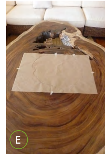
E Toma de plantilla para trazo en software Inventor.
