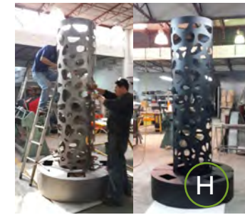
H Chimenea en planta, proceso de armado I.
