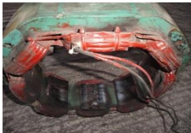
Fig. 4.8 Daño en los polos del estator de excitación.
