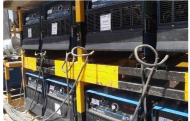
Fig. 4.28 Vista frontal de un rack de soldadoras.
