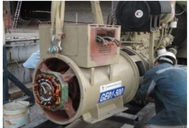
Fig. 4.10 Armado de generador reparado.
