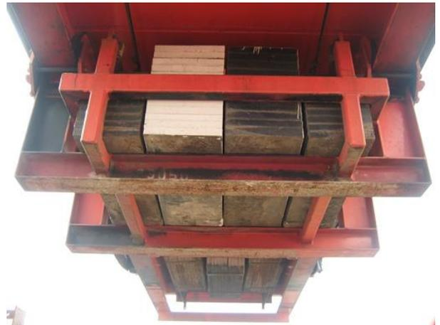
Fig. 2.15 Bloques de contrapesos móviles en carro.
