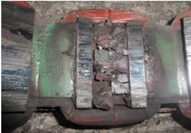
Fig. 4.9 Detalle de polo dañado en el estator.
