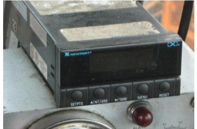
Fig. 2.22 Indicador de peso de la carga.
