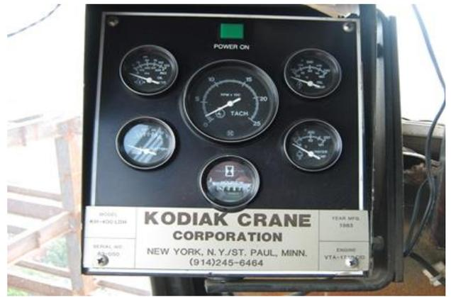
Fig. 2.20 Instrumentación del motor diésel.
