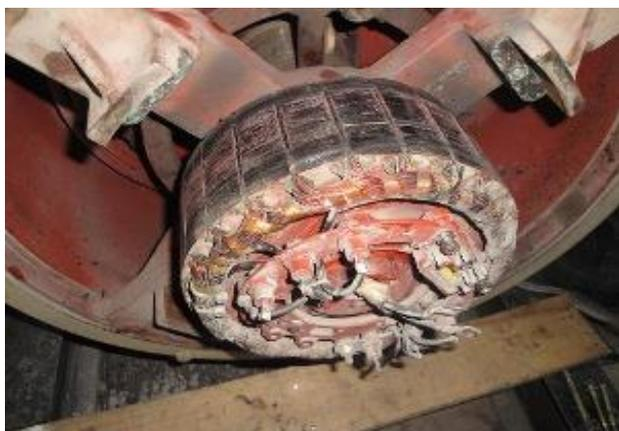
Fig. 4.7 Daño en el colector del Rotor de excitación.
