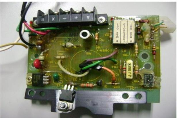
Fig. 2.26 Tarjeta electrónica del joystick.
