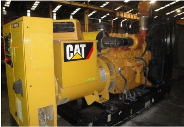
Fig. 4.16 Generador Caterpillar de 650kVA sin gabinete acústico.
