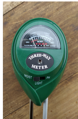
Medidor de pH de 3 vías, luz y humedad
