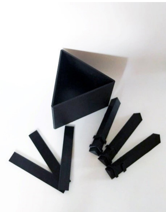
Fig. 19. Prototipo impreso en 3D en el laboratorio del Posgrado de Diseño Industrial con postproceso y armado. Fotografía de la autora, 2022
