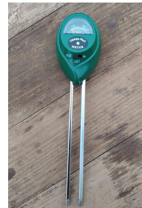
Medidor de pH de 3 vías, luz y humedad
