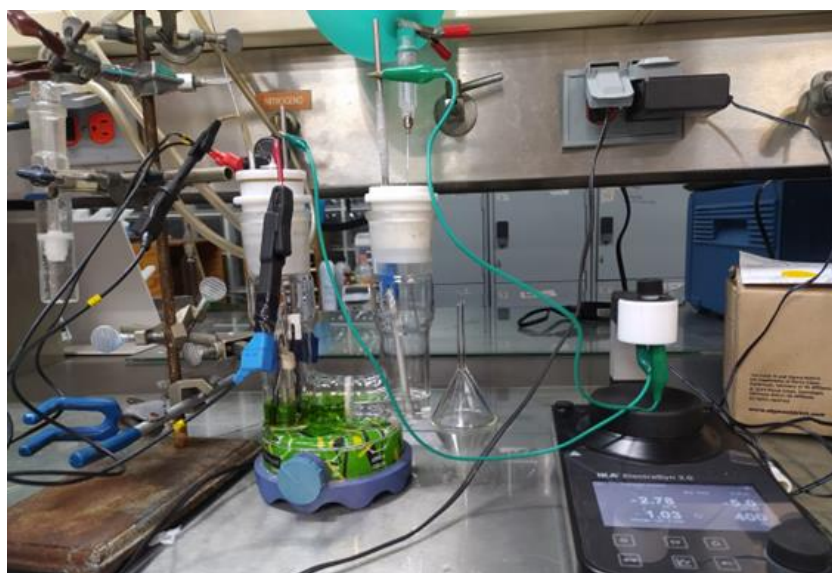
Figura 52. Montaje experimental. Las conexiones en verde corresponden a los electrodos usados para ECC y las conexiones negras y roja a los electrodos usados en LSV. El catolito gana una coloración verde intensa.
