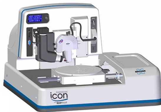
Figura 4. 6 Microscopia de fuerza atómica- Veeco Dimension Icon, utilizado en este trabajo para las mediciones morfológicas de las muestras.
