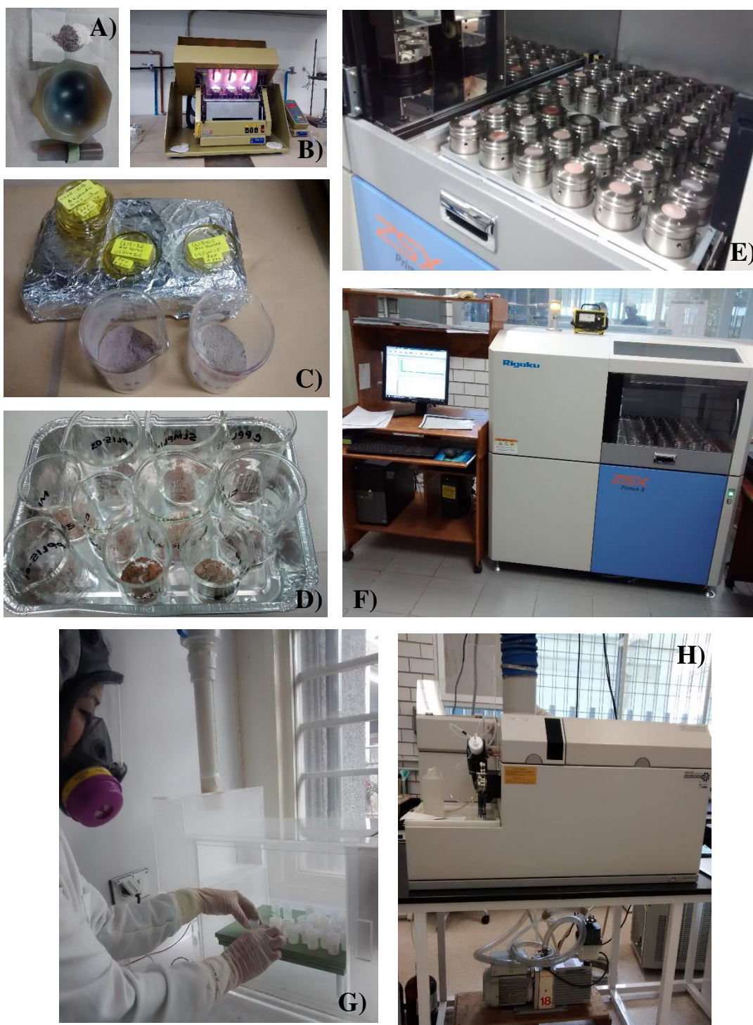
Figura 30. Ejemplificación de metodología y algunas técnicas analíticas empleadas: A) Mortero de ágata, utilizado para homogenizar muestras; B) Instrumento de fusión marca CLAISSE; C y D) Polvos de roca en preparación y perlas generadas con el instrumento de fusión; E) Montaje de pastillas y perlas para análisis por la técnica de FRX; F) Equipo de Fluorescencia de Rayos X marca RIGAKU; G) preparación de muestras con la técnica de digestión en ácidos; y H) Espectrometría de Masas con Plasma Acoplado Inductivamente (ICP).
