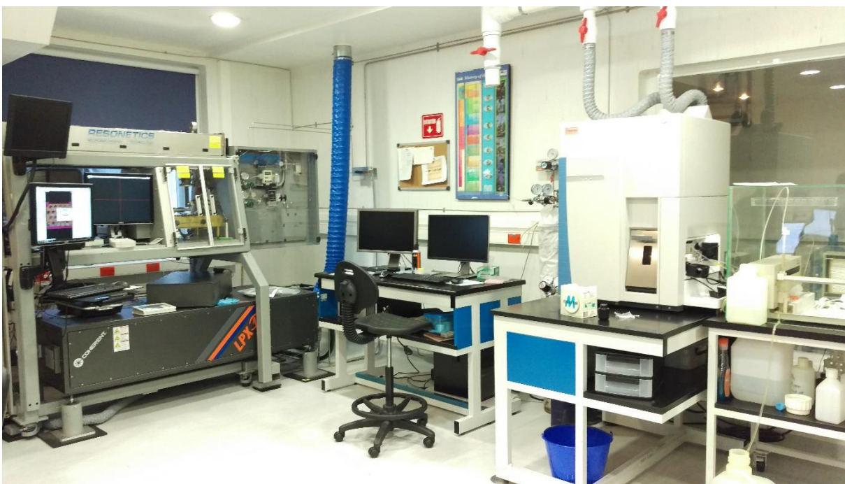
Figura C2.- Espectrómetro de masas ICP-MS tipo cuadrupolo marca “Thermo X-Series”, en la parte derecha. En la parte izquierda se observa el sistema de ablación láser.
