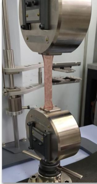
**Figura 2.2.** Prueba de tensión para probetas de resina
