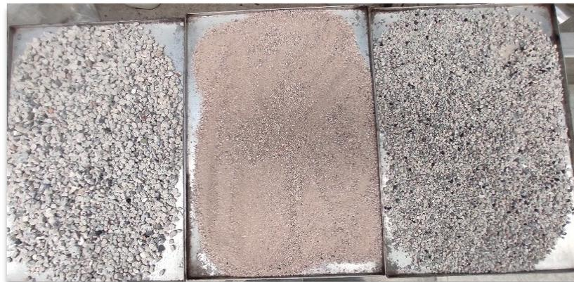
**Figura 2.3.** Gránulos de concreto reciclado. De izquierda a derecha: 9.5 mm, arena y 6.4 mm
