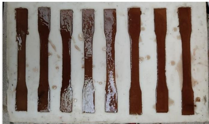
**Figura 2.1.** Curado de resina en el molde de silicón para formar las probetas
