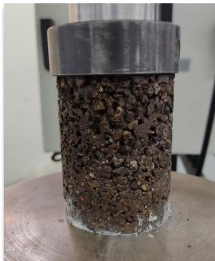
**Figura 2.5.** Ensayo de compresión de concreto permeable
