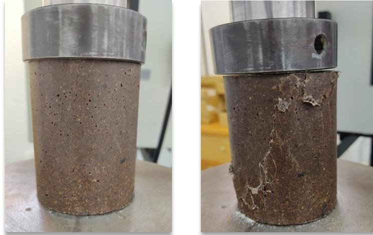
**Figura 2.6.** Probeta de concreto impermeable antes (izquierda) y después (derecha) del ensayo de compresión
