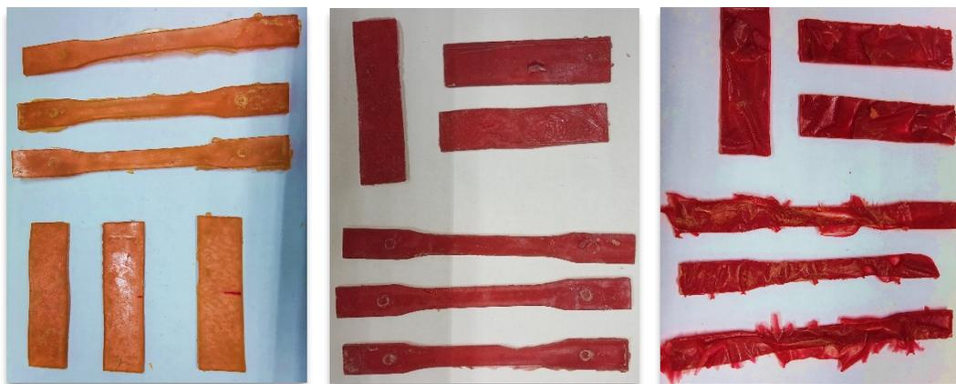
**Figura 3.1.** Probetas de resina con 0 %, 0.5 % y 1 % de tinta (de izquierda a derecha)
