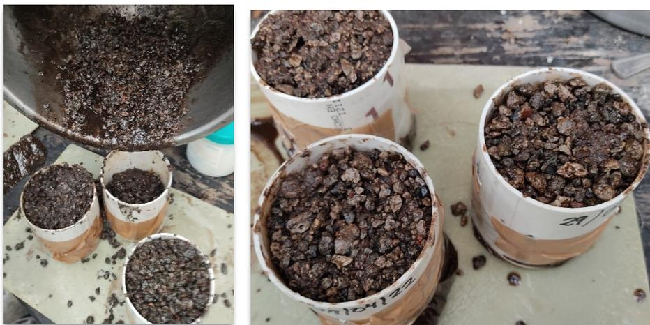
**Figura 2.4.** Llenado de los tubos para probetas de concreto
