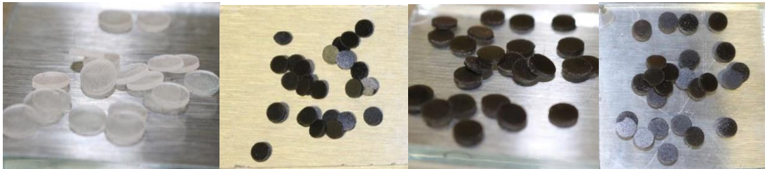
Figura 33. Discos de acondicionador de tejidos a) sin Nps Ag_2S , b) con Ag_2S al 1% en peso c) con Ag_2S al 2% en peso y d) con Ag_2S al 4% en peso. Fuente propia.
