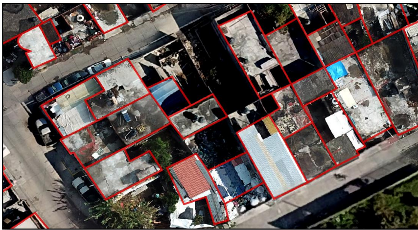
Figura 18. Digitalización de los techos con base en la ortofoto obtenida mediante drones.
