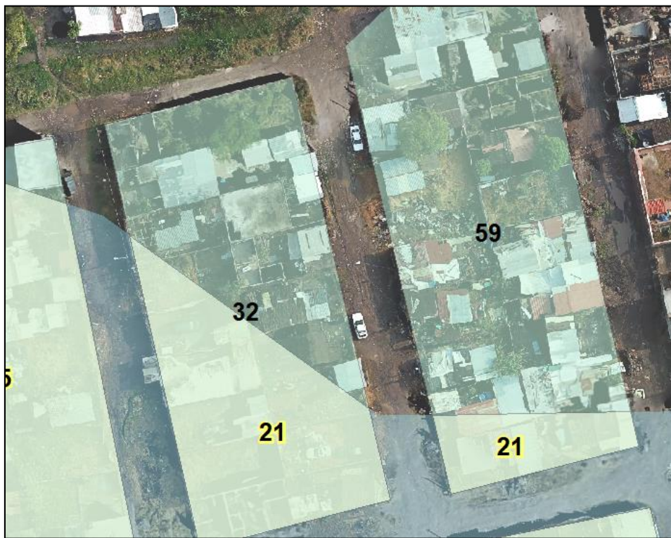
Figura 17. Esquema de cómo se aplica la técnica del prorrateo, en números negros se observa la población total de la manzana, según INEGI, en amarillo la población obtenida mediante la técnica del prorrateo tomando solo las viviendas en zona inundable.
