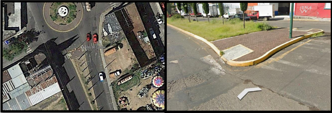
Figura 9. Forma de obtener posibles puntos de control usando Google Earth y Stree View.
