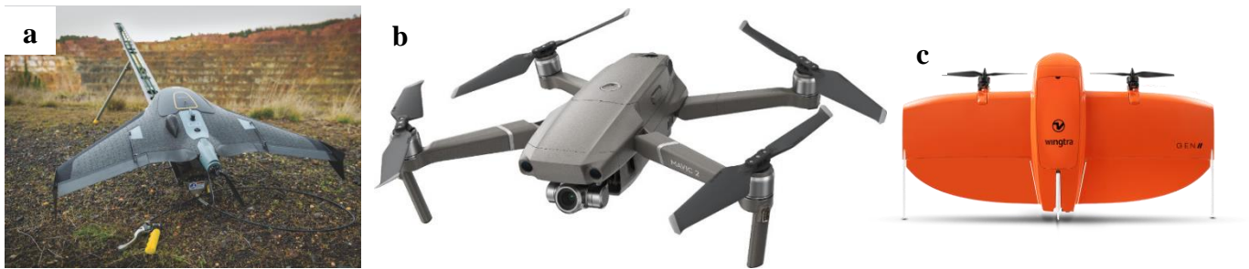
Figura 4. Tipos de drones: a) ala fija, y b) Ala rotatoria y c) Ala mixta.
