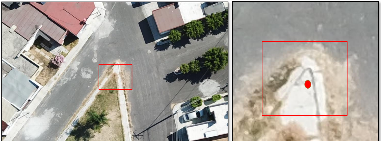
Figura 25. Se muestra como se observa uno de los puntos de control (P10) en las imágenes obtenidas con el dron.
