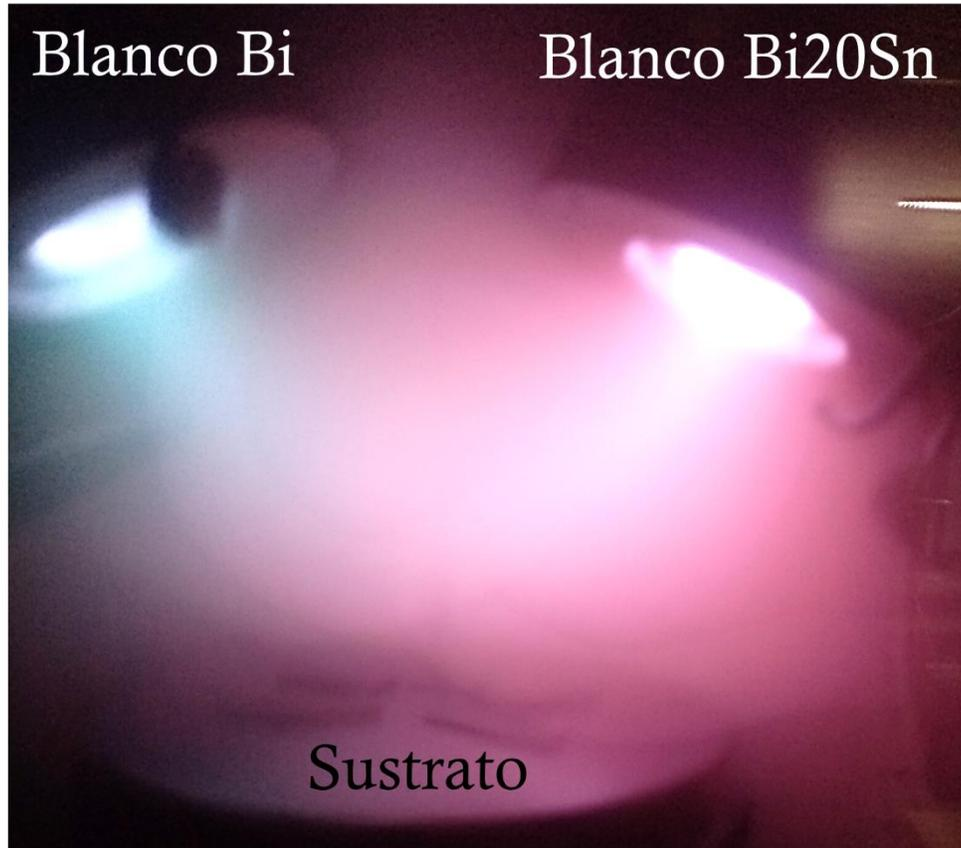
Figura 8. Interior de la cámara de co-depósito empleando dos magnetrones con diferentes blancos.
