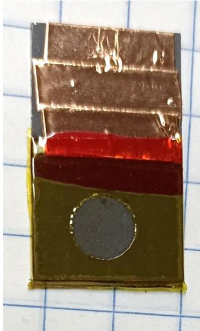
*Figura 15. Electrodo empleado durante las pruebas de SWASV con área delimitada.*
