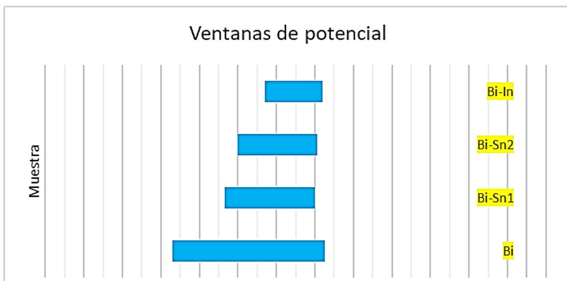
Figura 42. Intervalos de las ventanas de potencial obtenidas de las muestras. Nótese que la adición de Sn o In como dopante reduce el rango de la ventana.
