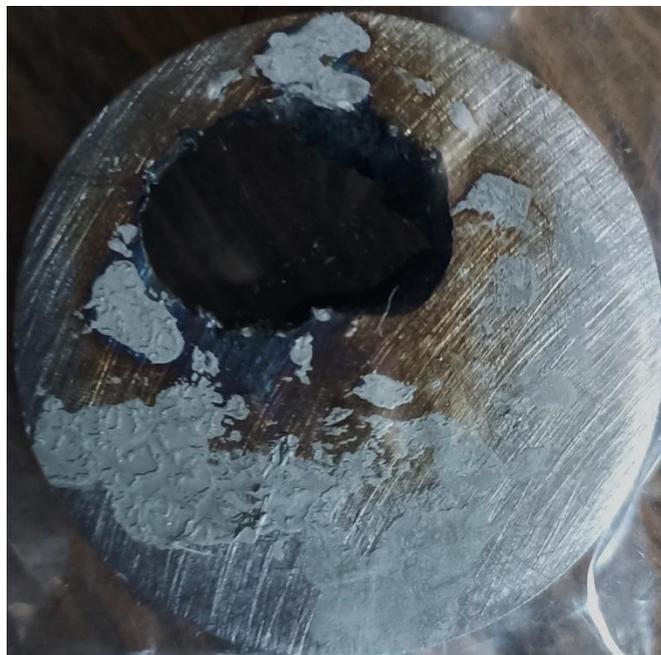
*Figura 10. Blanco fallido de Bi parcialmente fundido debido a la alta energía suministrada durante el co-depósito por un periodo de tiempo prolongado.*
