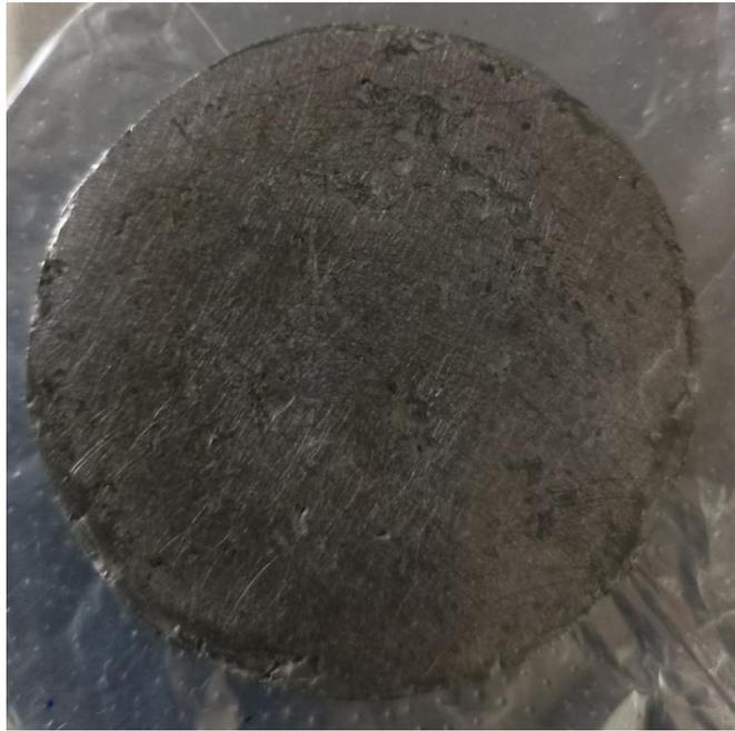
*Figura 9. Blanco de Bi puro empleado durante los depósitos de las muestras de Bi y Bi-Sn1.*
