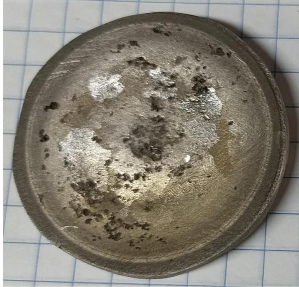
Figura 13. Blanco de Bi5In empleado para los depósitos de las muestras de Bi-In.
