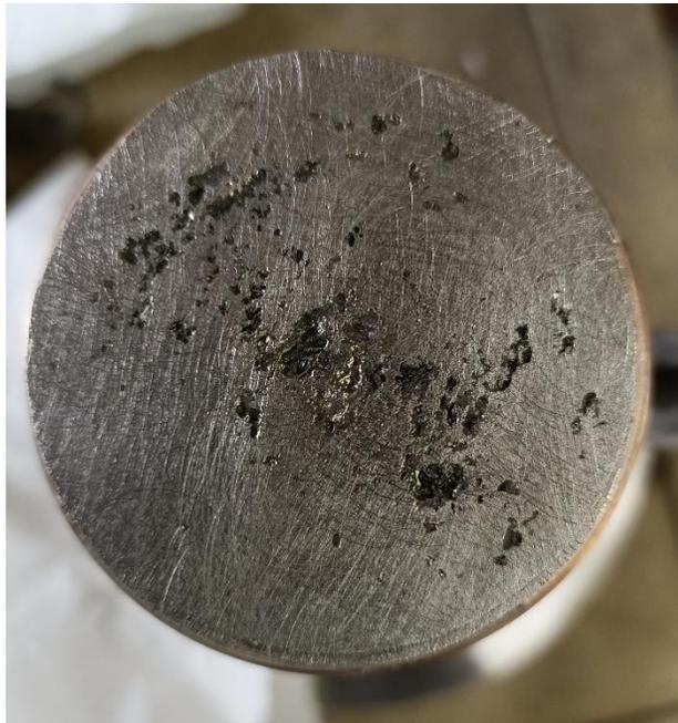
*Figura 11. Blanco de Bi<sub>20</sub>Sn empleado para los depósitos de las muestras de Bi-Sn1 y Bi-Sn2.*
