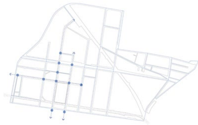
A Plano de red de agua potable.
