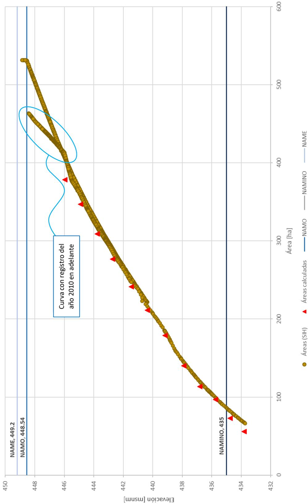
Figura 23, Curvas E-A con registro de CONAGUA y datos calculados con SIG, QGIS-Excel 2022.
