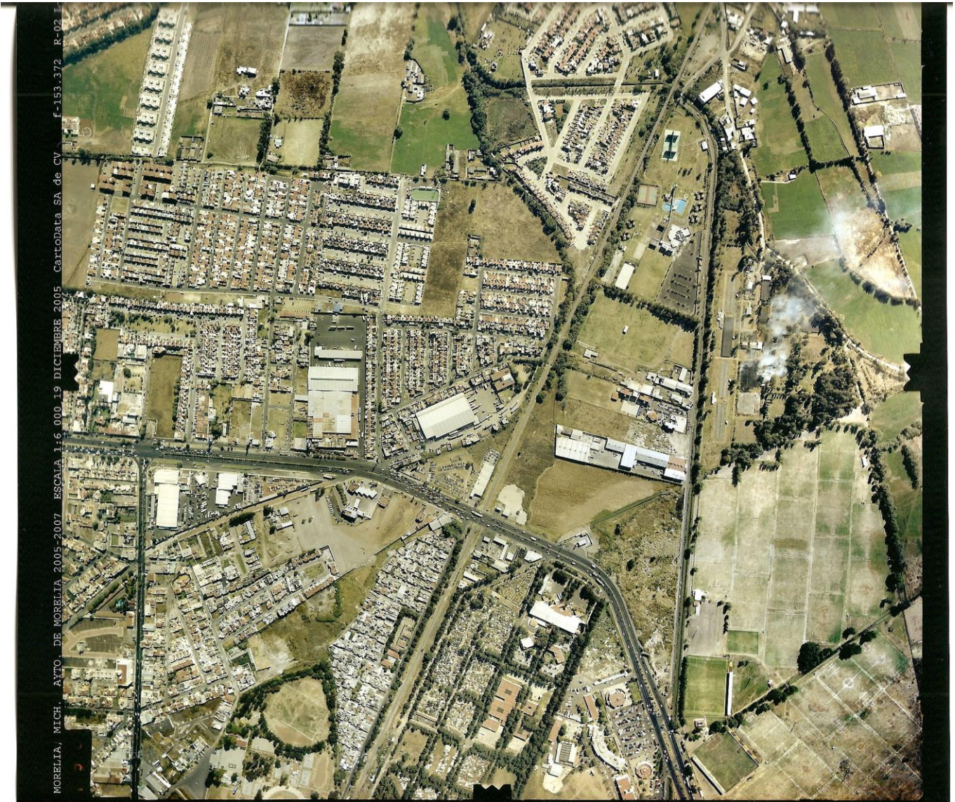
Figura 36. Ejemplo de una fotografía aérea (contacto) resultado directo del proyecto realizado, con los datos fiduciales.
