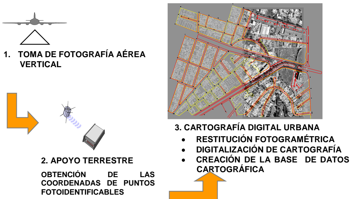
Figura 15. Proceso general de la fotografía aérea y la cartografía digital
