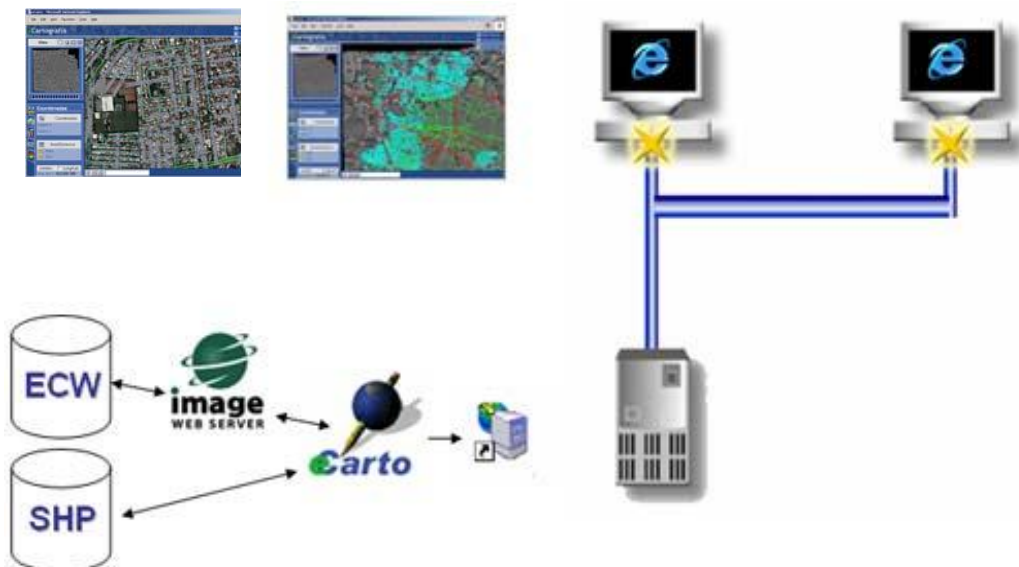
Figura 33. Diagrama de componentes y relaciones del sistema eCarto
