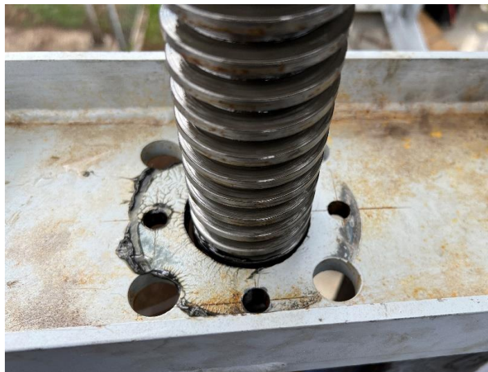
Figura 39. Detalle de ajuste de usillo con placa de montaje superior.
