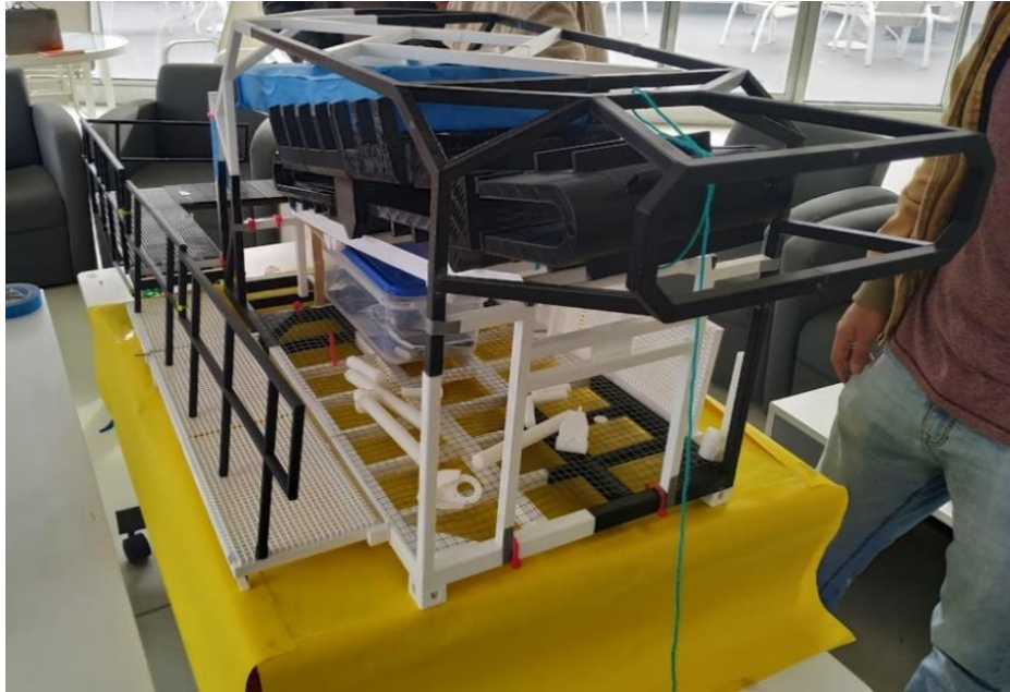
Figura 21. Modelo completo de Sistema “Todo en Uno” hecho con FDM.
