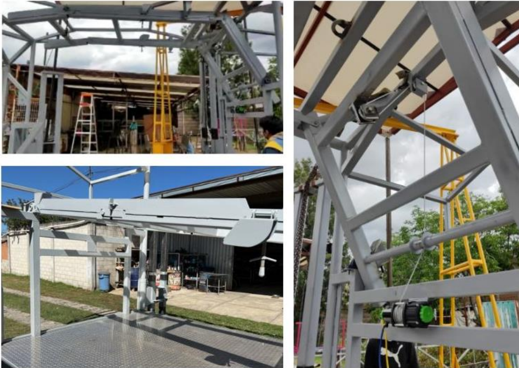
Figura 37. Fotografías tomadas a rampa de guardado fabricada, se detalla al mecanismo de repliegue de la misma.
